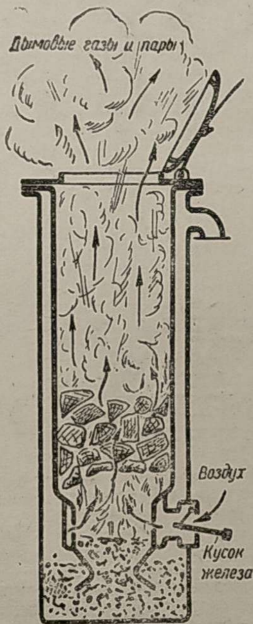
Схема движения воздуха и продуктов горения топлива при розжиге газогенератора через загрузочный люк
