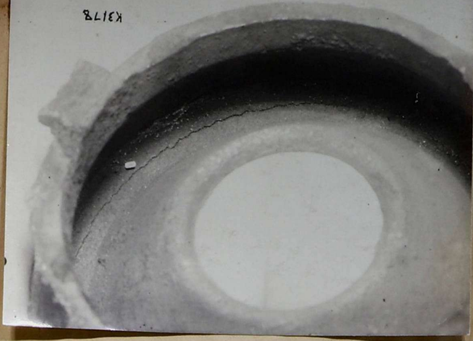
Фиг. 14. Усадочная трещина, образца Б.
