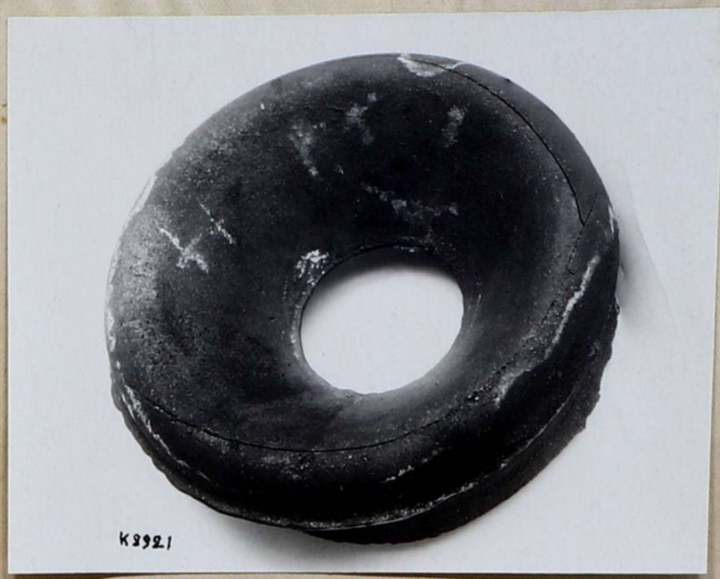
Фиг. 20а Трещина в образце Б.
