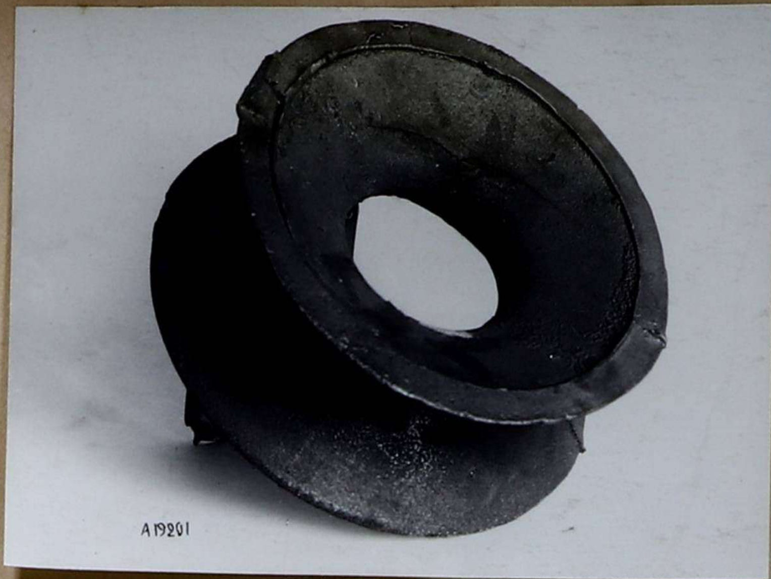
Фиг. 20 б Трещина в образце А
