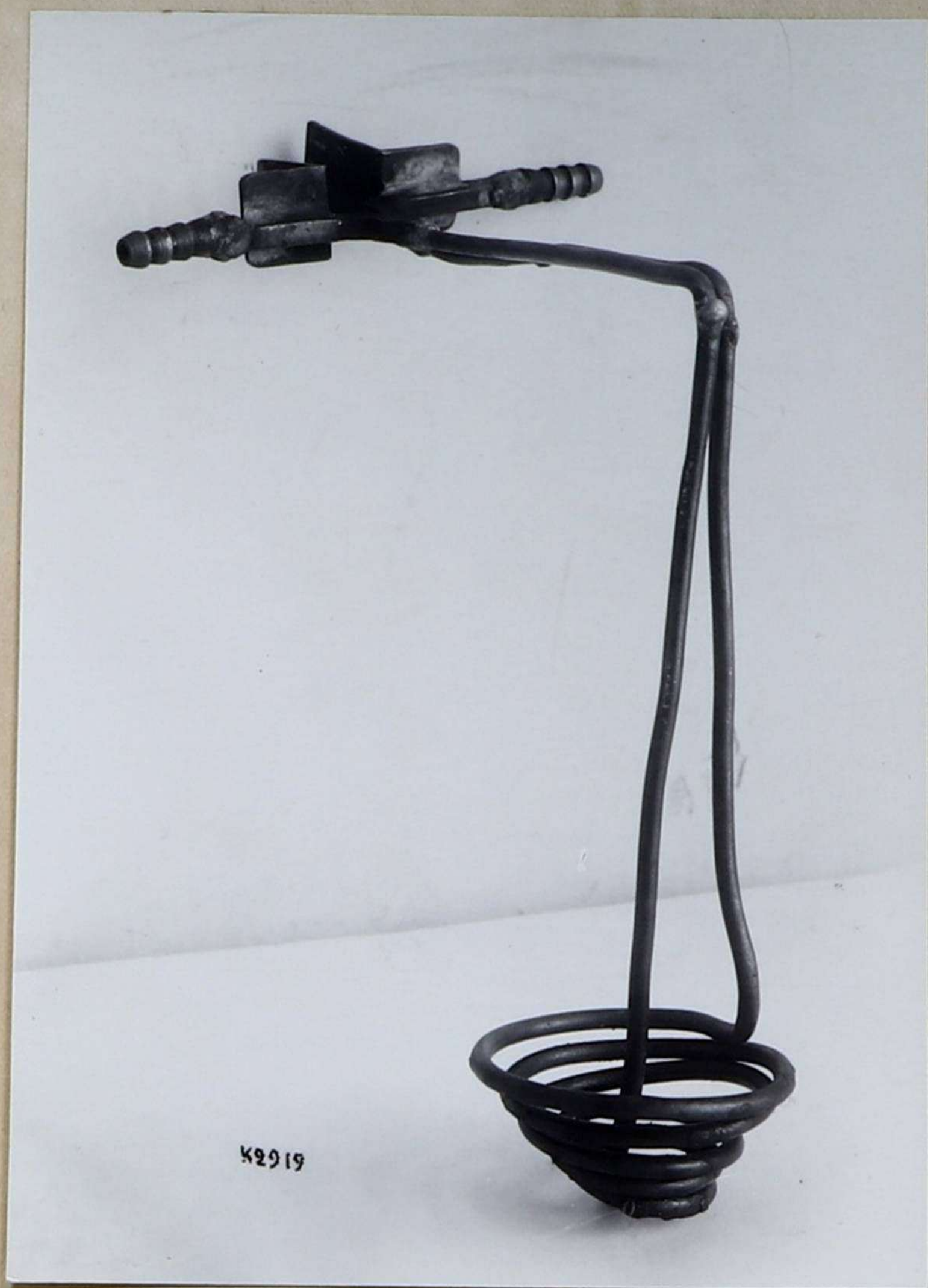
Фиг. 18 Индуктор для нагрева образца Б.
