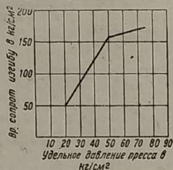
Рис. 2. Зависимость механической прочности плит от прессования
