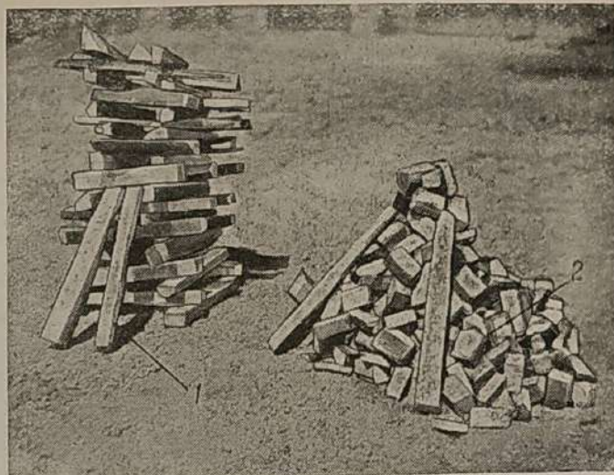
Рис. 3. Газогенераторное топливо: 1—швырковые дрова длиной 50 см; 2—чурки для газогенераторов
