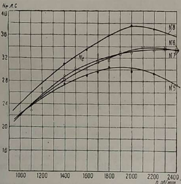
Рис. 2. Кривые мощностей двигателя ЗИС-5. Топливо: смесь свежесрубленных березовых чурок с углем и саксаул (опыты 5-8)
