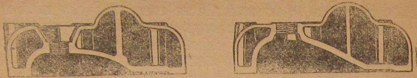
Рис. 11. Головка блока газогенераторного двигателя. Головка блока бензинового двигателя.
