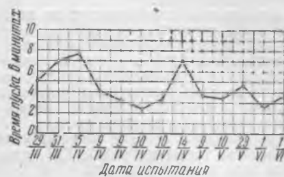
Рис. 6. Продолжительность пуска холодного двигателя автомобиля ЗИС-31
