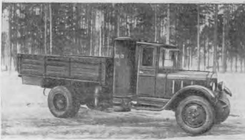
Рис. 1. Общий вид газогенераторного автомобиля ЗИС-31
