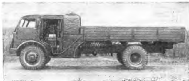
Рис. 1. Паровой автомобиль НАМИ-012 (капот машинного отделения открыт)
