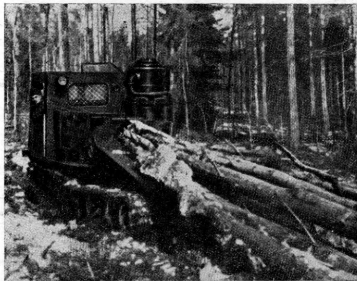
Рис. 4. Трактор КТ-12 с двигателем ГД-30 на производственных испытаниях в Лужском лесномхозе (1953 г.)
