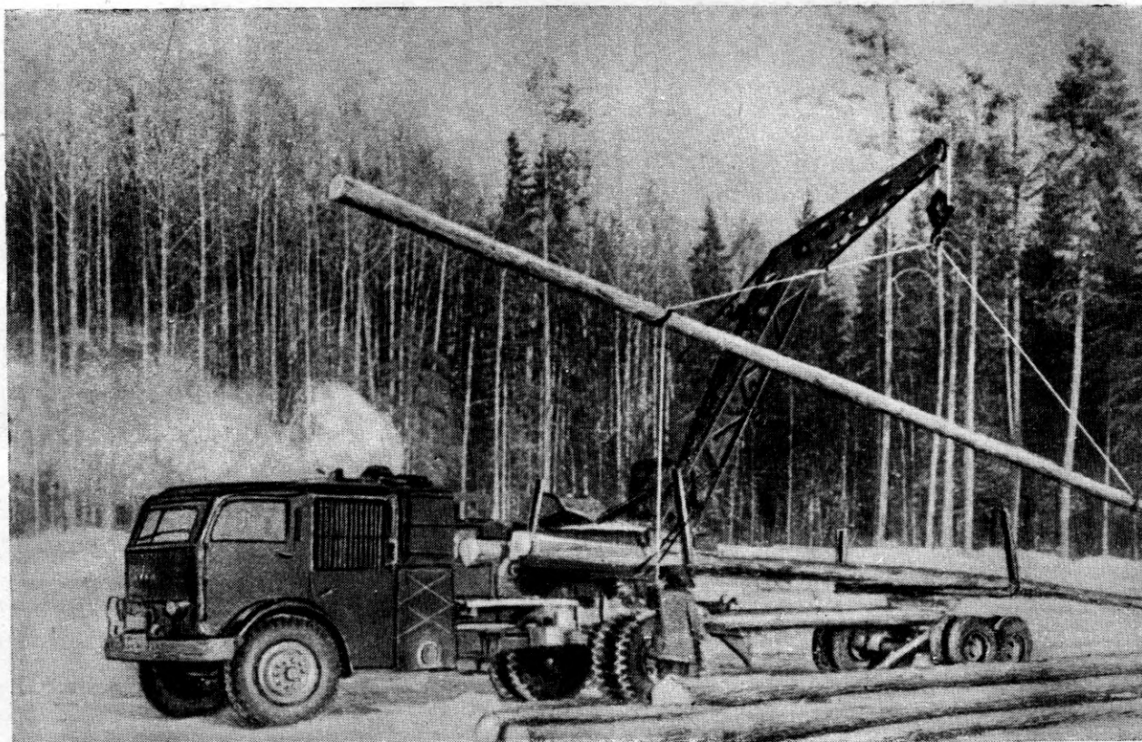
Рис. 1. Погрузка хлыстов на автомобиль НАМИ-012 на верхнем складе.
