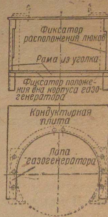
Рис. 3. Кондуктор-шаблон для изготовления корпуса газогенератора
