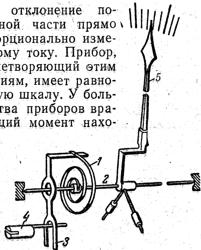
Рис. 12-6. Пружина и корректор прибора.
