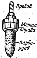
Рис. 17-47. Карборундовый зажигатель (игнитрон).
