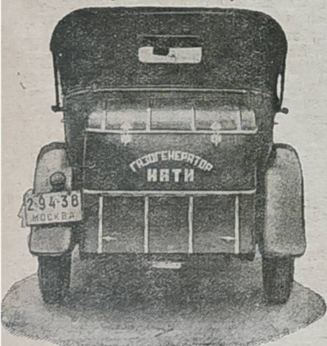
Рис. 1. Автомобиль ГАЗ-А с газогенераторной установкой Г-12.
