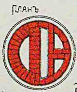
Наружный воздухопріемный каналъ
