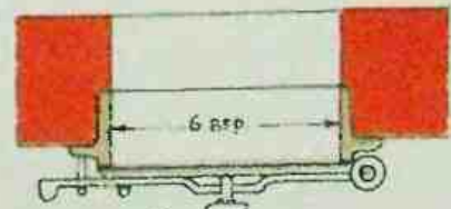
Вертикальный разрьбъ двуполотной чугунной загрузочной дверцы съ глазкомъ во внутреннемъ полотнѣ.
