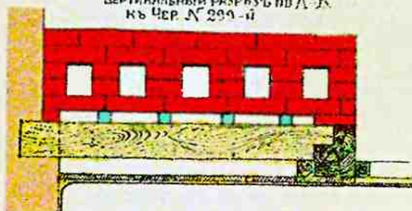
Чер. № 302-й Основаніе подъ печь на плоскихъ бетонныхъ плитахъ по желѣзнымъ балочкамъ. Планъ основанія
