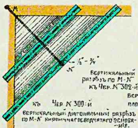
Чер. № 300-й Сводчатое кирпичное или бетонное основаніе между желѣзными балочками
