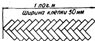
Рис. 264. Схема размещения клепок на 1 пог. м «елки» паркета.
