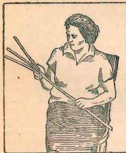
Рис. 26. Раскалывание прута вручную колунком
