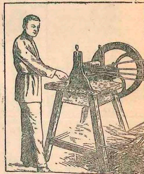
Рис. 27. Раскалывание прута механизированным способом на станке «шиф»
