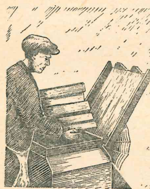
Рис. 189. Загрузка швырка в газогенератор горизонтального типа
