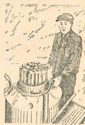
Рис. 190. Загрузка швырка в газогенератор вертикального типа
