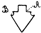
Рис. 34. Продольная линейка или прогонокъ въ поперечномъ разрѣзѣ: А — мѣсто вставки стеколь, В—желобокъ для стока воды.
