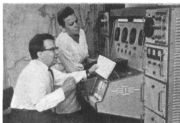
Изобретатель сейсмостанции «Сахалин» инженер А. И. Верченко и старший техник-конструктор Т. А. Еремина за настройкой приборов
