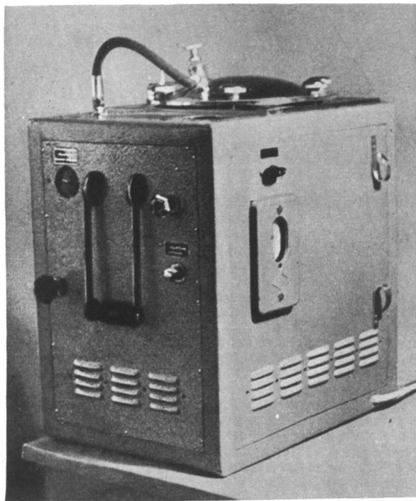
Переносный аппарат для консервации почки, сконструированный в Научно-исследовательском институте клинической и экспериментальной хирургии группой инженеров и врачей. В нем почка хранится в специальной жидкой среде при температуре до +4^{\circ} и повышенном кислородном давлении
