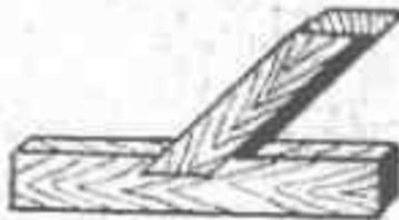
Ярунок - применяется для расчерчивания линий под углом  $45^\circ$  и  $135^\circ$ .
