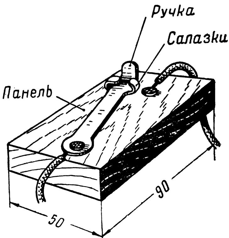
Рис. 29. Рычажковый выключатель.
