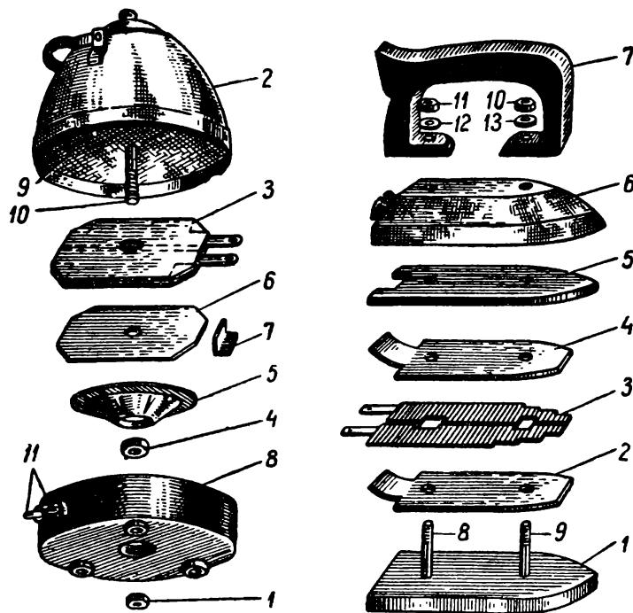
Рис. 92. Разборка электрочайника и электроутюга.
