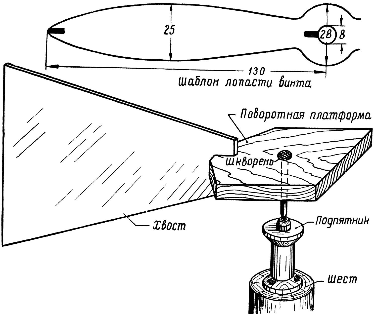
Рис. 133 Детали ветродвигателя.
