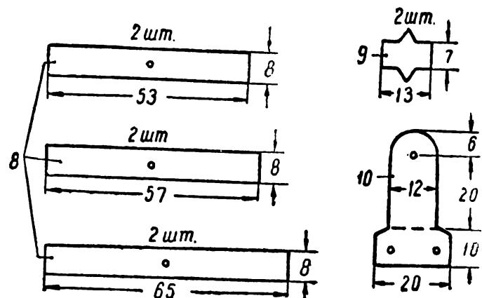
Рис. 117. Детали для электромотора:
