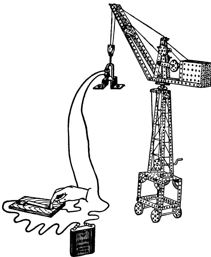
Рис. 101. Схема включения электромагнита.
