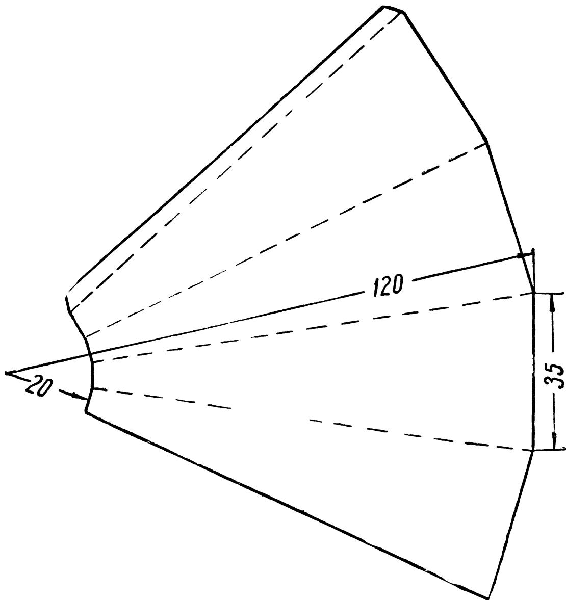
Рис. 50 Чертеж корпуса фонаря.
