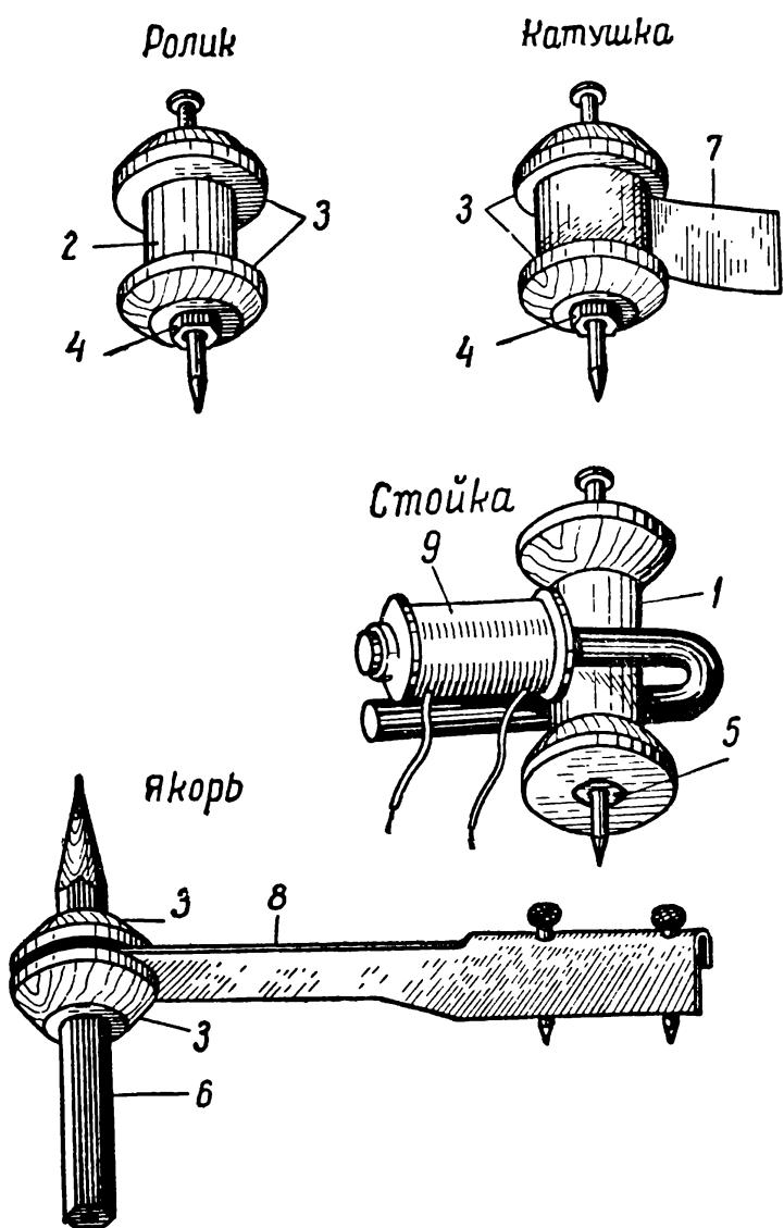
Рис. 111. Сборка телеграфного аппарата.
