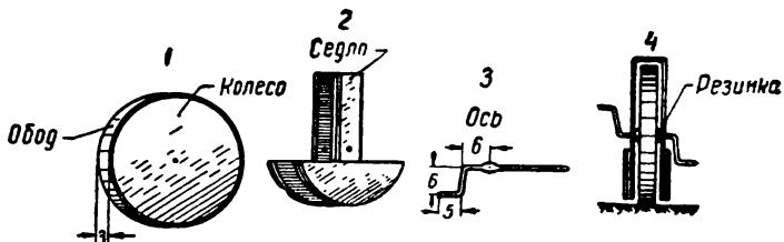
Рис. 144. Изготовление велосипеда (цифрами указан порядок работы).
