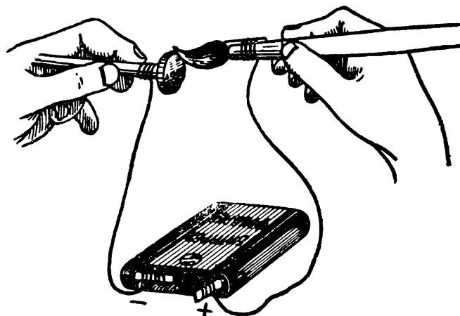
Рис. 87. Гальваническое покрытие металлов.
