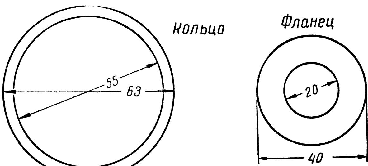
Рис. 128. Регулировочное кольцо для трубы и фланец для рупора.
