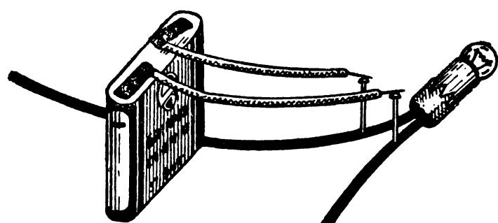
Рис. 69. Проверка исправности лампочки.
