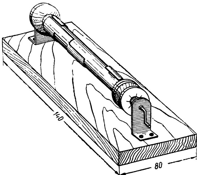
Рис. 72. Механический переключатель.
