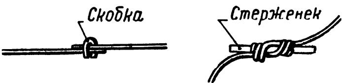
Рис. 91. Сращивание перегоревшей спиралей.
