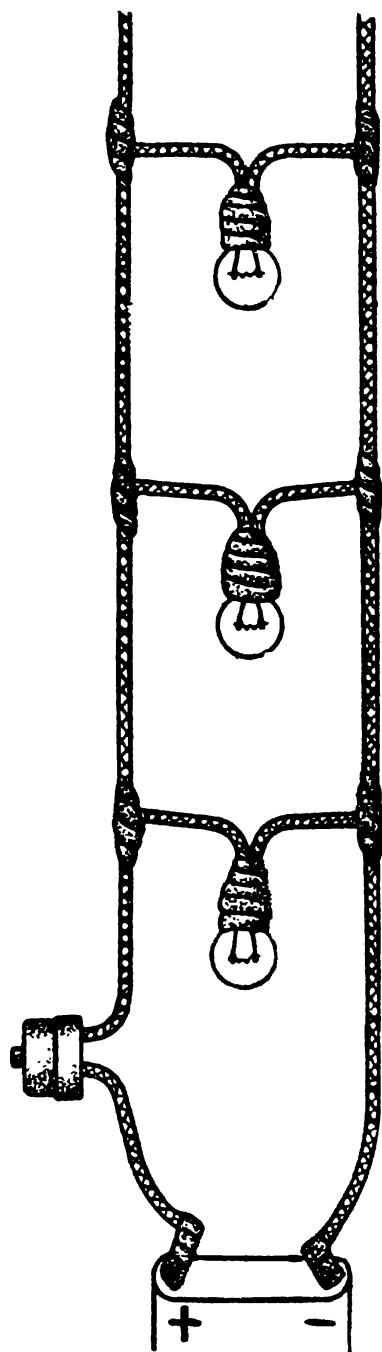
Рис. 57. Параллельное соединение.
