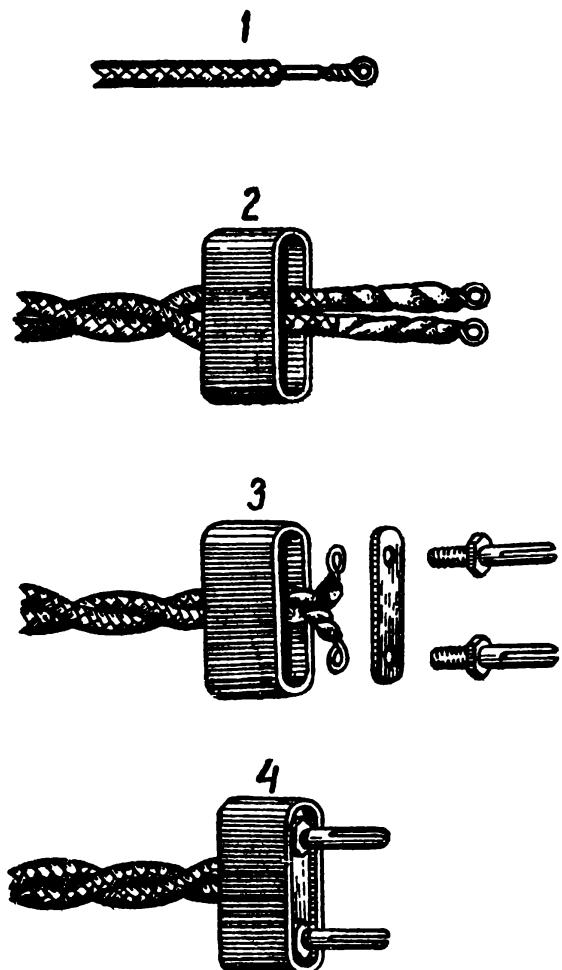
Рис. 88. Зарядка штепсельной вилки (цифрами показан порядок работы).
