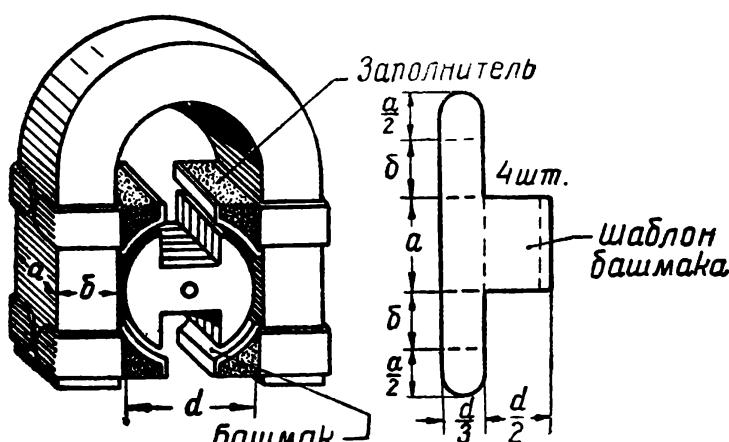
Рис. 131. Установка полюсных башмаков.
