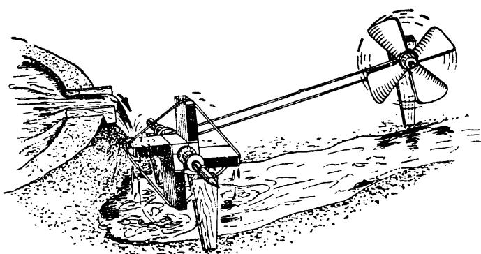
Рис. 22. Установка водяного колеса под плотину.
