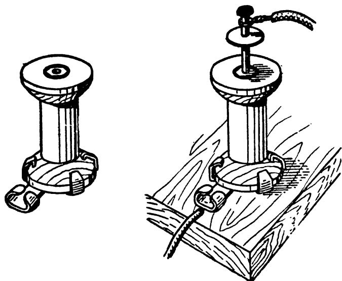
Рис. 33. Сборка ползункового выключателя.
