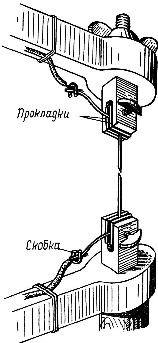
Рис. 82. Присоединение проводов к зажимам металлического лобзика.
