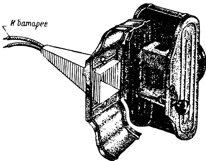
Рис. 51 Установка проекционного фонаря.
