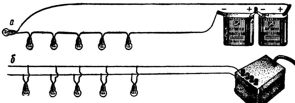
Рис. 68. Схемы включения елочной электрогирлянды:
