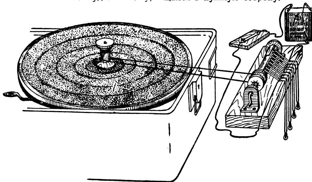
Рис. 74. Привод переключателя от патефона.
