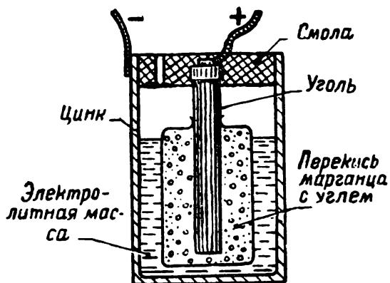
Рис. 63. Устройство сухого элемента.
