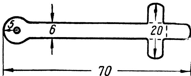
Рис. 30. Чертеж рычажка.
