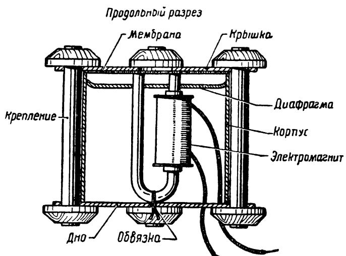
Рис. 126. Сборка трубы.
