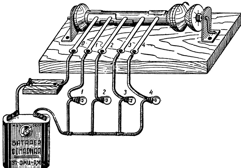
Рис. 73. Включение механического переключателя по схеме «блуждающий огонек».
