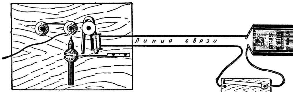
Рис. 113. Телеграфный аппарат в собранном виде (вид сверху).
