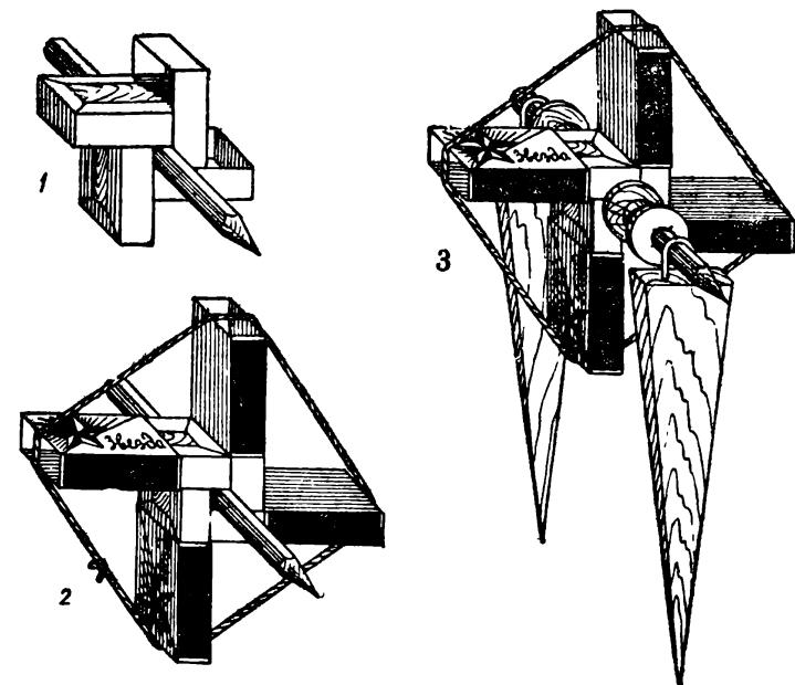
Рис. 17. Сборка водяного колеса.
