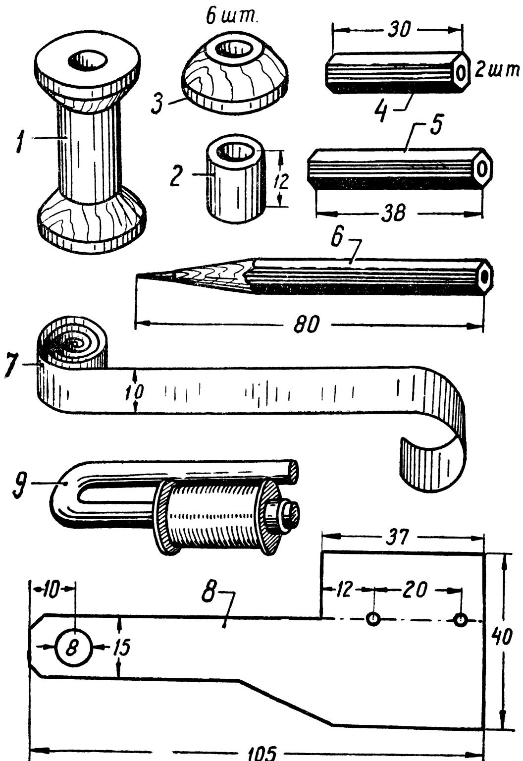
Рис. 110. Детали для телеграфного аппарата:
