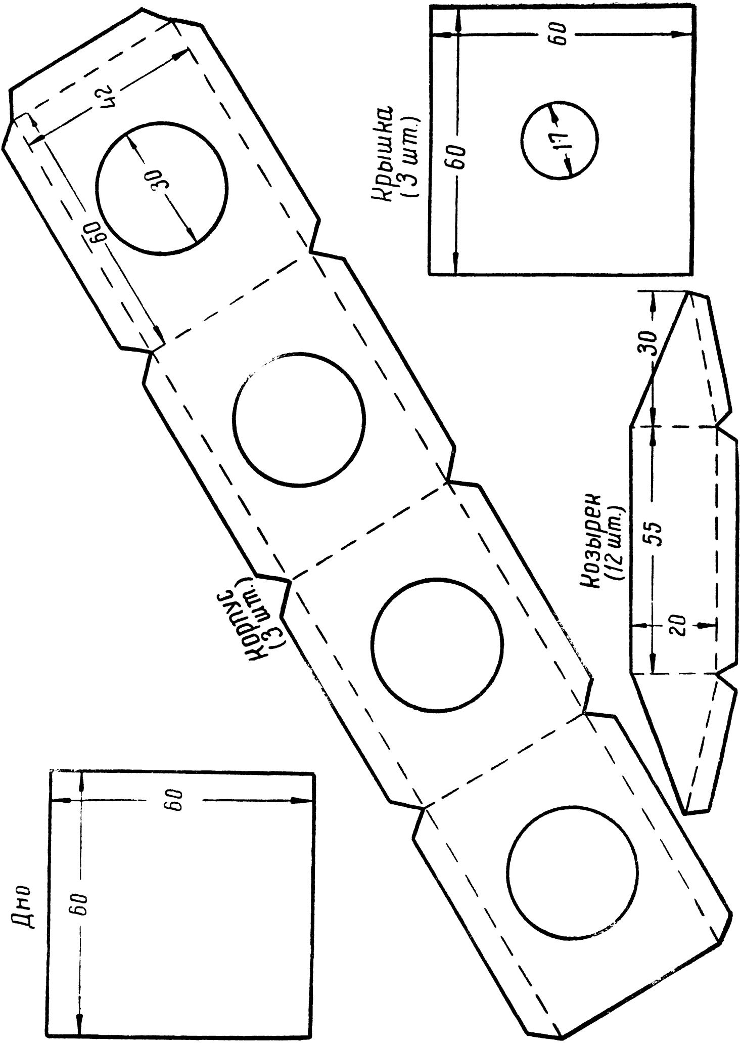
Рис. 61. Детали светофора.
