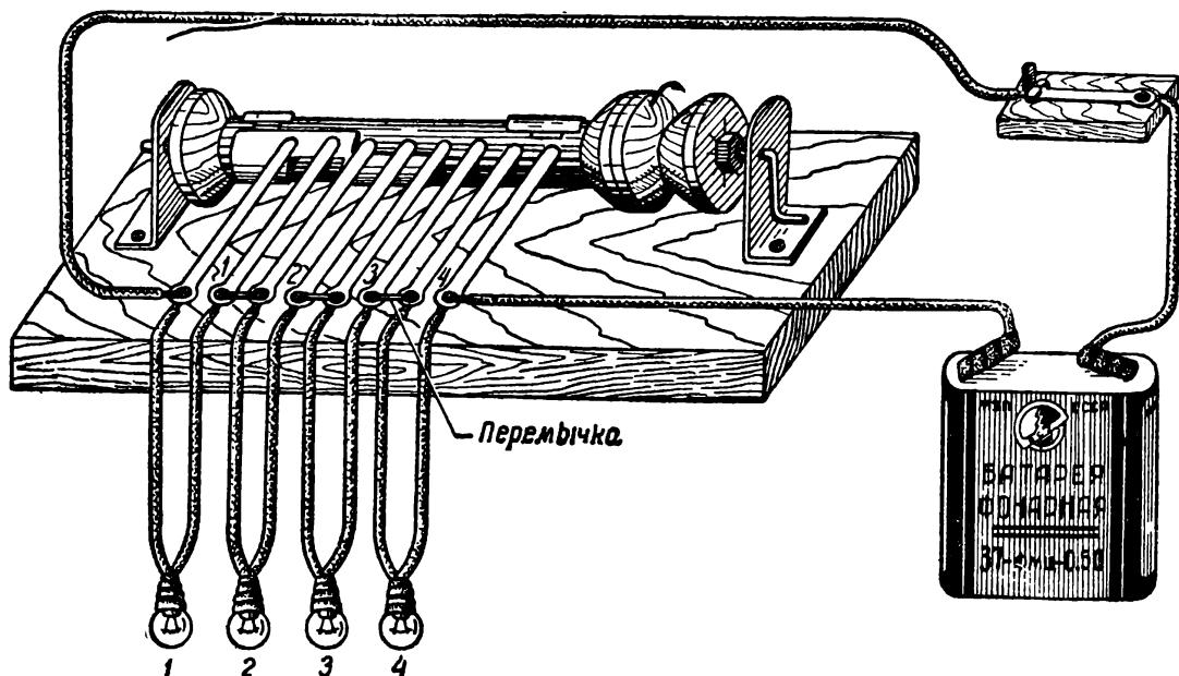
Рис. 75. Включение механического переключателя по схеме «бегающий зайчик».
