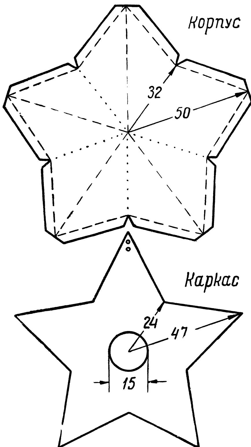
Рис. 46. Детали звездочки.
