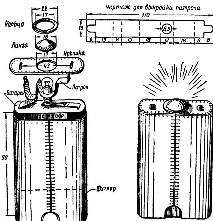
Рис. 62. Карманный электрический фонарь.
