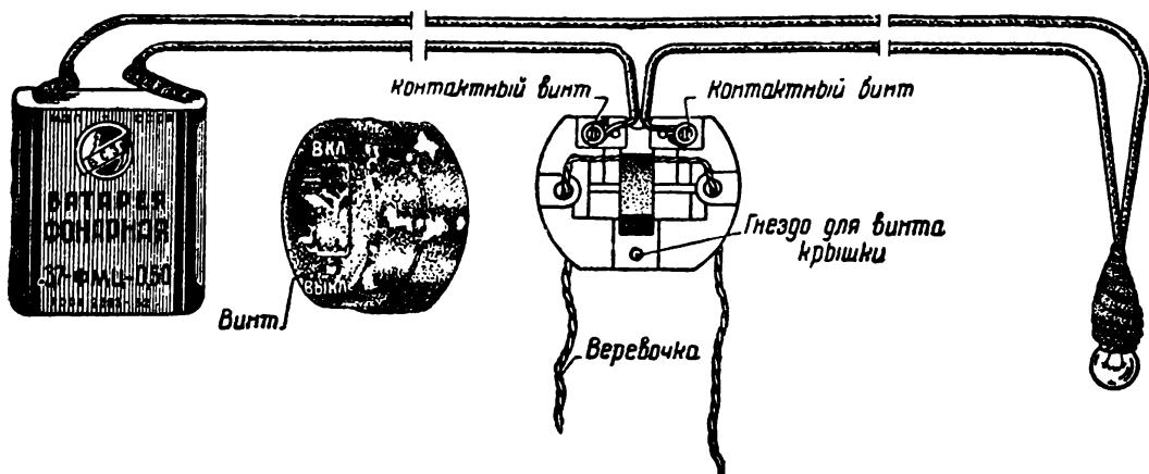
Рис. 53. Присоединение выключателя.
