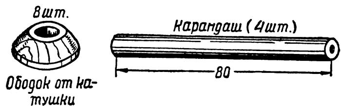
Рис. 125. Крепежные детали для телефонной трубы.
