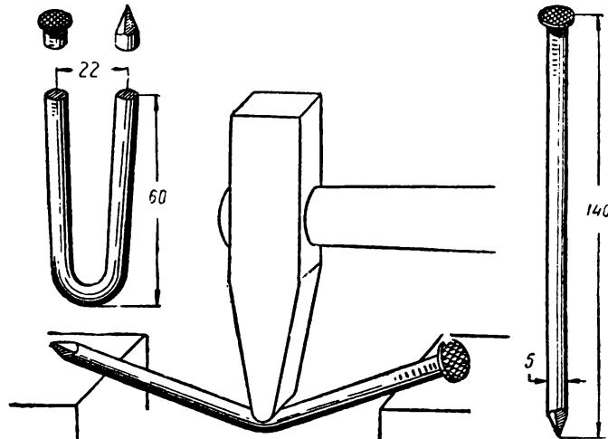
Рис. 97. Изготовление сердечника.
