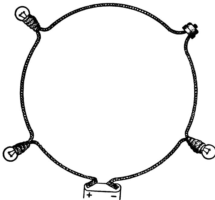
Рис. 57. Параллельное соединение.
