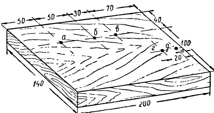
Рис. 112. Разметка панели.
