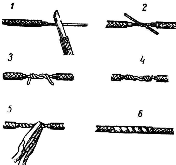
Рис. 12. Сращивание проводов (цифрами указанна очередьность работ).
