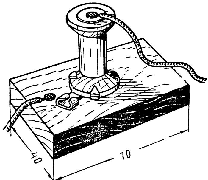
Рис. 31. Ползунковый выключатель.
