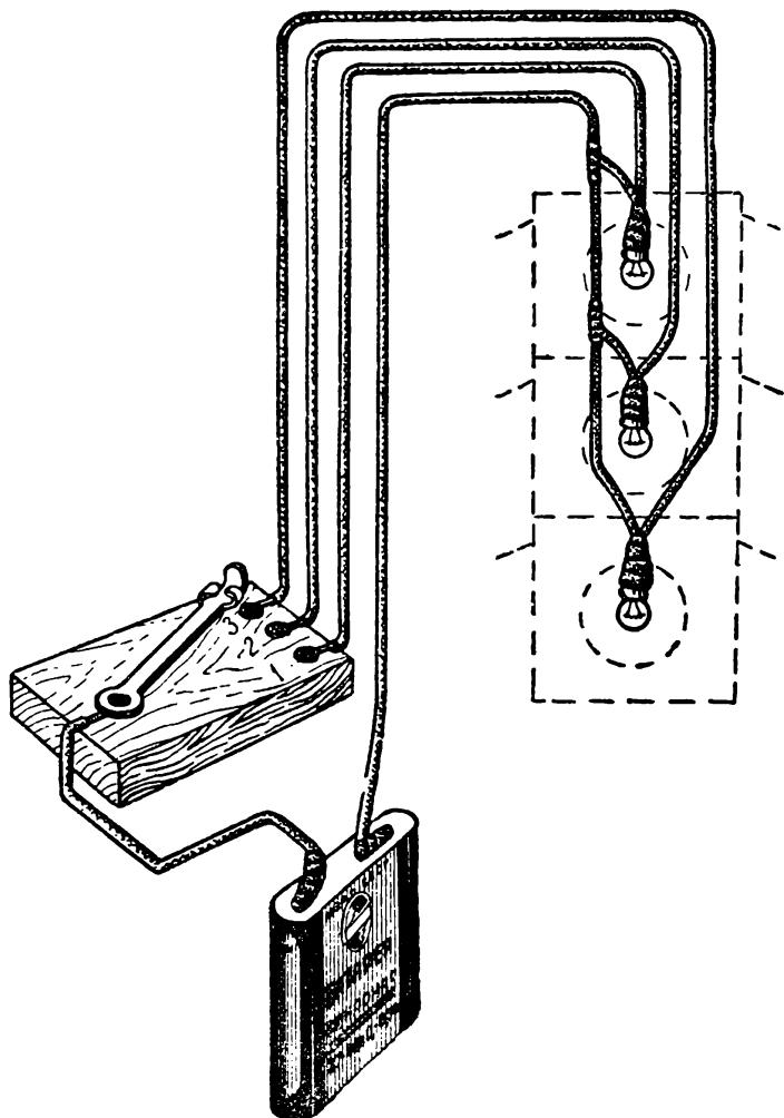
Рис. 60. Схема включения светофора.
