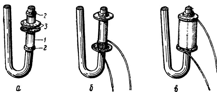
Рис. 99. Сборка и обмотка катушки:
