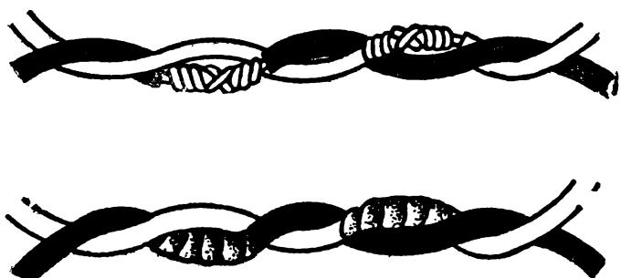
Рис. 14. Расположение сращений на парном проводе.
