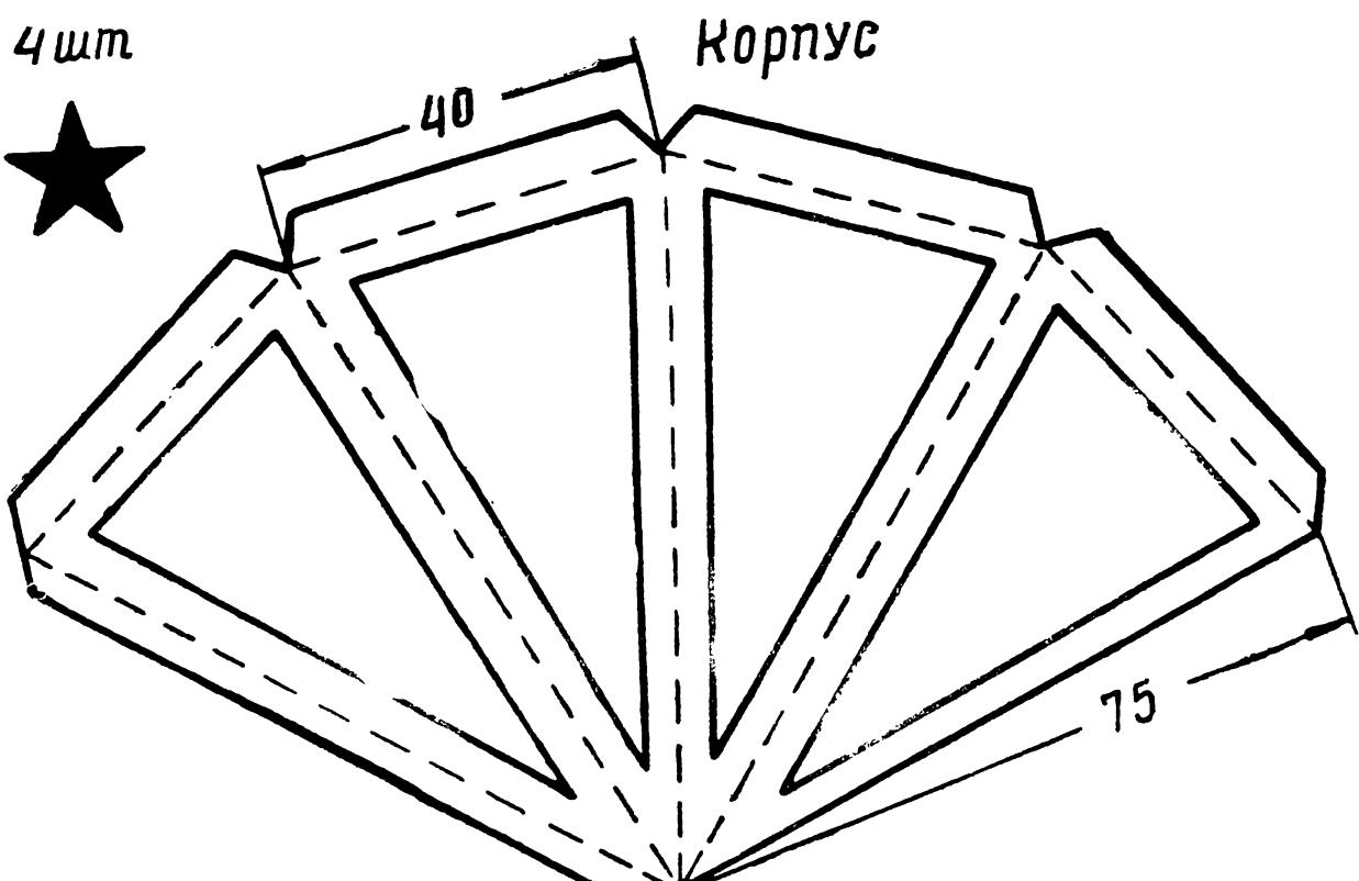
Рис. 39. Детали фонарика.
