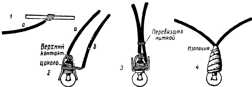
Рис. 27. Изготовление патрона.
