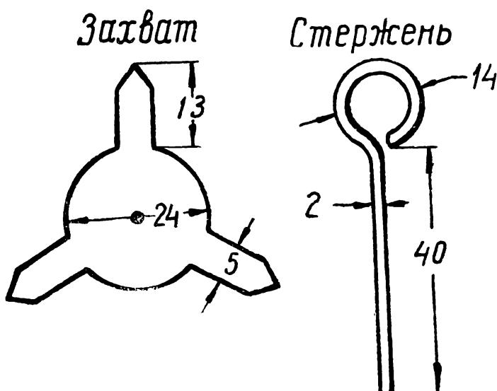
Рис. 34. Детали для кнопочного выключателя.
