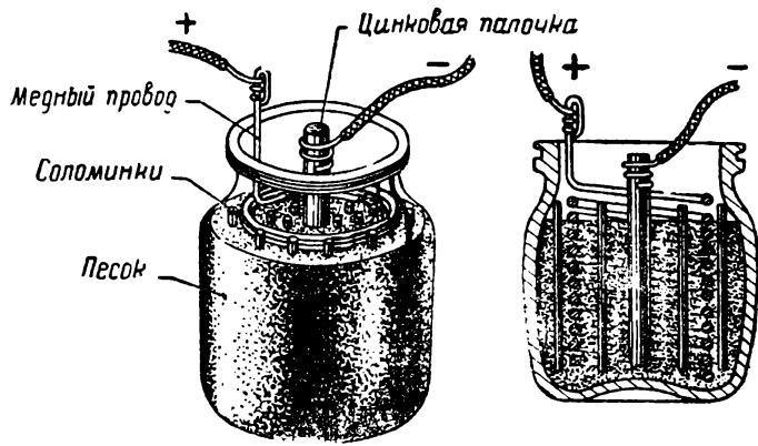
Рис. 67. Самодельный элемент.
