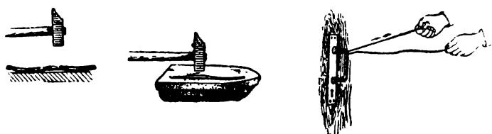
Рис. 11. Выпрямление проволоки и провода.
