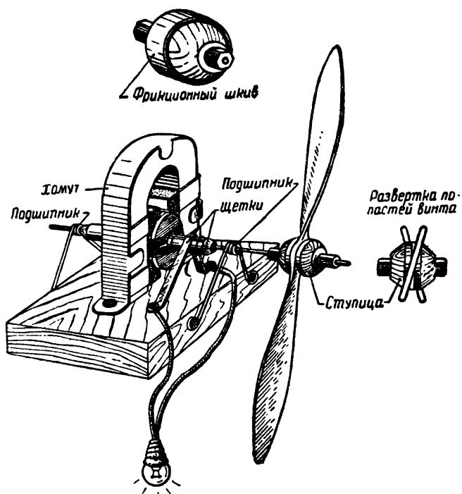
Рис. 132. Генератор электрического тока.
