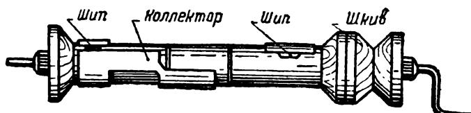
Рис. 71. Сборка барабана переключателя.
