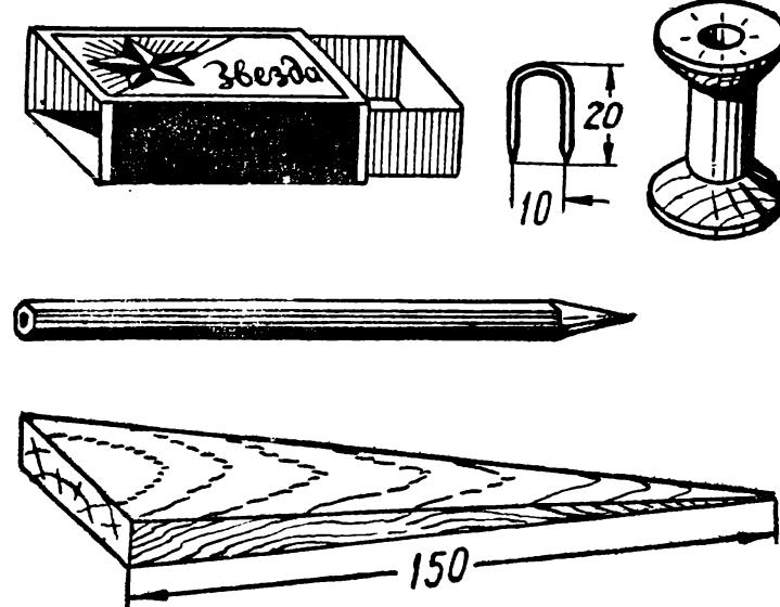
Рис. 16. Детали для водяного колеса.
