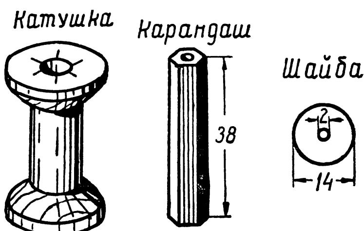
Рис. 32. Детали для ползункового выключателя.
