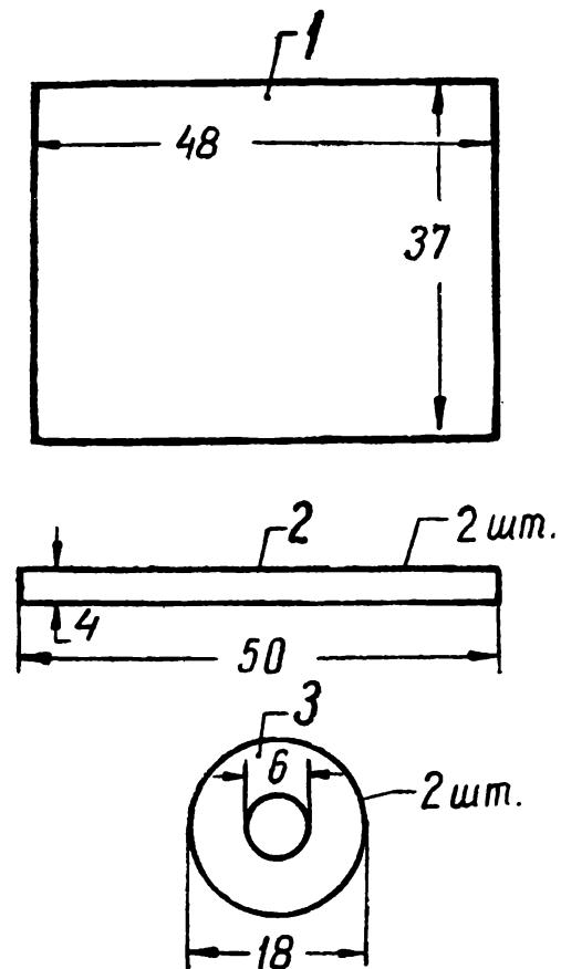
Рис. 98. Выкройка деталей катушки электромагнита:
