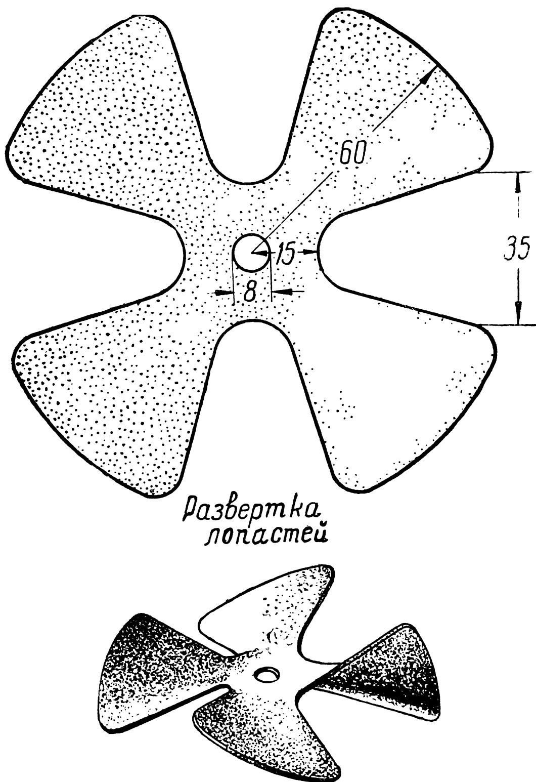
Рис. 19. Крылья вентилятора.
