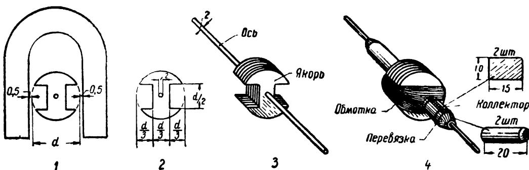
Рис. 130. Изготовление ротора генератора (цифры показывают порядок работы).
