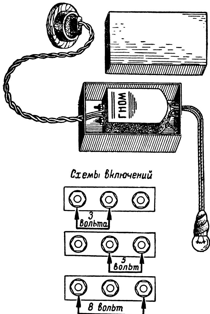
Рис. 66. Звонковый трансформатор «Гном».
