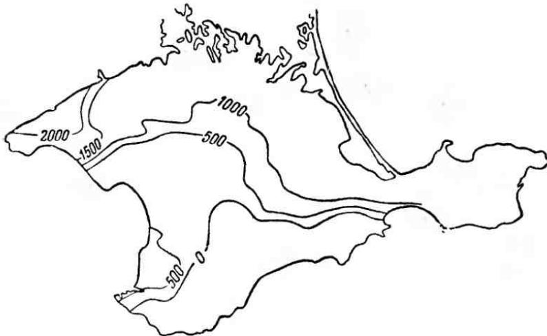
Рис. 49. Схема распространения суммарных мощностей отложений верхнего мела по данным бурения. Составлена А. Е. Каменецким
