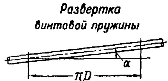
Рис. 74. Развертка винтовой пружины.
