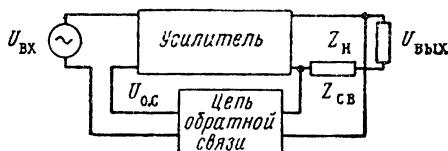
Фиг. 5.33. Блок-схема усилителя со смешанной обратной связью.
