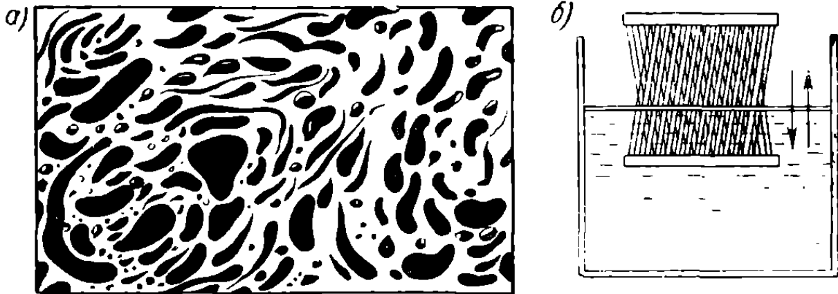
Рис. 24. Схема отделки акваграфией:
