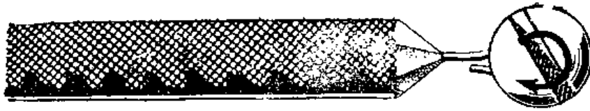
Рис. IV.81. Виток провода должен охватывать контактный винт по часовой стрелке.
