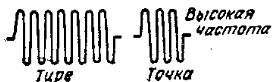
Рис. VI.144. Точки и тире, представляющие собой сигналы международного кода Морзе. Они получаются при прерывании незатухающих высокочастотных колебаний.
