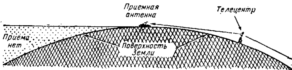
Рис. VI.172. Так как телевизионные сигналы распространяются прямолинейно, антенны нужно поднимать как можно выше.
