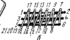
Рис. 123. Процессы изготовления малой и большой закрепок на машине 220-М кл.
