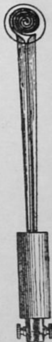
Рис. 138. Висмутовая спираль для измѣренія магнитнаго поля.
