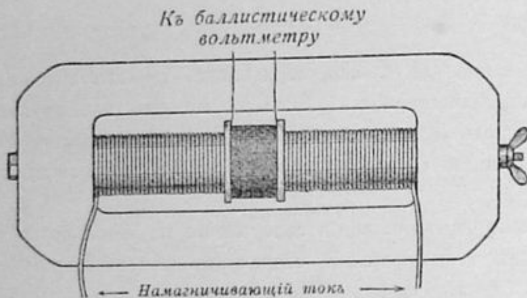
Рис. 224. Магнитное „ядро“ Гопкинсона (схематически).
