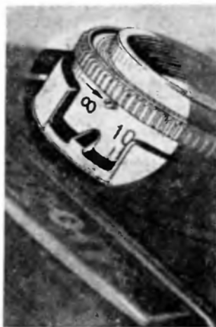
Рис. 41. Стопорные винты (на окружности оправы объектива)
