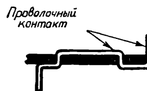
Рис. 79. Установка контакта на панели
