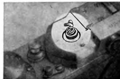
Рис. 47. Шейка фиксатора скоростей. Пружина и винт крепления, находящиеся под головкой скоростей
