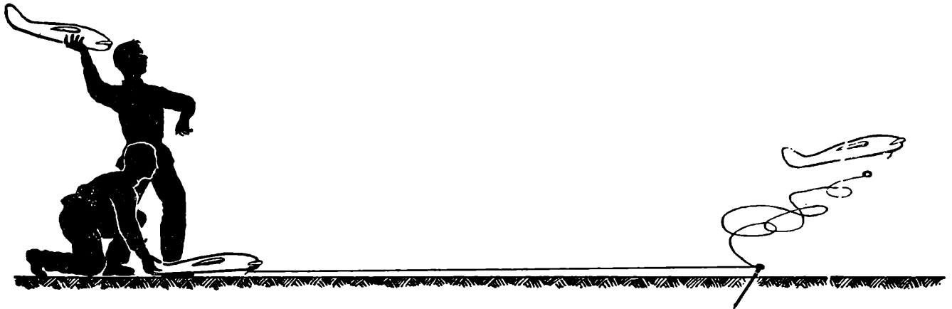
Рис. 27. Запуск модели на резиновом шнурке и с рук
