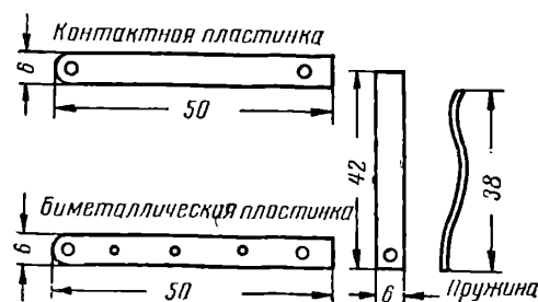
Рис. 58. Изготовление биметаллического реле
