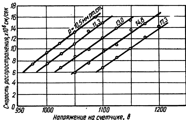
Рис. 46. Скорости распространения разряда в зависимости от давления и напряжения на счетчике при различной примеси спирта (10,5; 11,3; 13,0; 14,8; 17,3 мм рт. ст.) [18].
