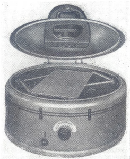
Ф и г. 3.5. Небольшая центрифуга настольного типа.
