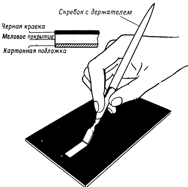
Фиг. 6.1. Изготовление оригинала схемы с помощью скребка.
