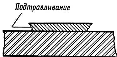
Фиг. 6.3. Подтравливание проводника в процессе травления фольги.
