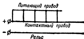
Рис. 3-14. Параллельное включение двух проводов для уменьшения потери напряжения.
