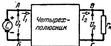
Рис. 5-2. Четырехполюсник с неизвестной схемой.
