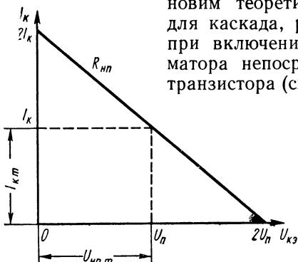
Рис. 5-6. Соотношения между напряжениями и токами в выходной цепи каскада при трансформаторной связи с нагрузкой
