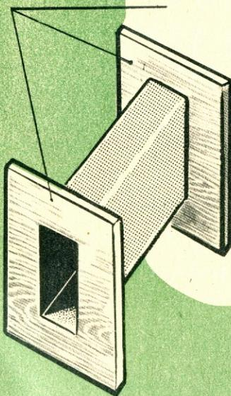
Мотать следует в одну сторону и каждый слой прокладывать папиросной бумагой с kleem. Начало и конец обмотки оставьте концами в 300 мм и выведите их в отверстия щечек катушки (см. рис.).
