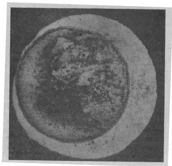
Рис. 48. Поперечный металлографический шлиф бракованного платинита (отклонение от соосности жилы и оболочки).
