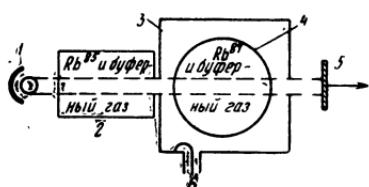
Рис. 5-2. Газонаполненная резонансная ячейка.
