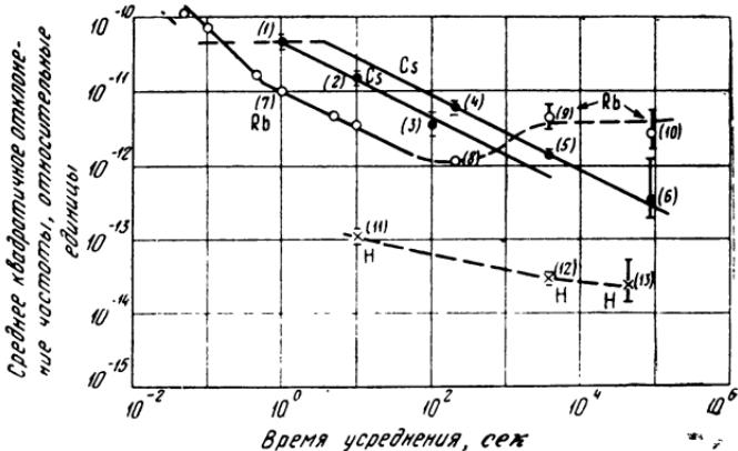
Рис. 5-7. Стабильность атомных эталонов частоты.
