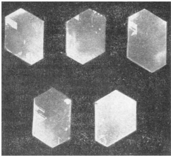
Рис. 1-16. Образцы бразильских двойников на травленой поверхности кристалла кварца.
