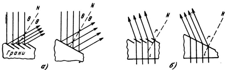
Рис. 1-11. Схемы, поясняющие эффект суммирования отраженных (а) или преломленных (б) лучей света одинаково наклоненными гранями фигур травления.
