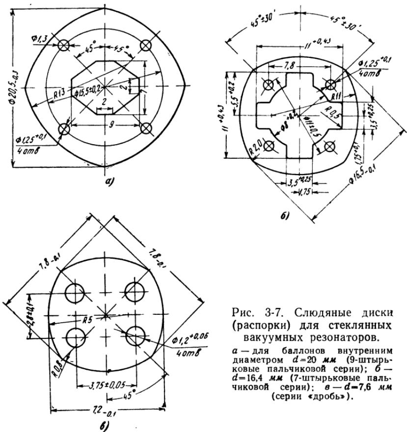
Рис. 3-7. Слюдяные диски (распорки) для стеклянных вакуумных резонаторов.
