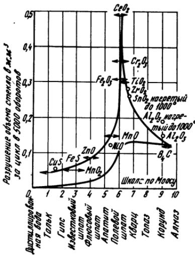
Рис. 2-5. Влияние твердости полировальных порошков на интенсивность полирования (по Бурже и Пайшесу).
