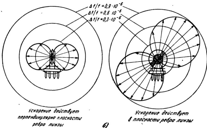
Рис. 3-20. Изменения частоты кварцевых резонаторов под воздействием линейных ускорений.
