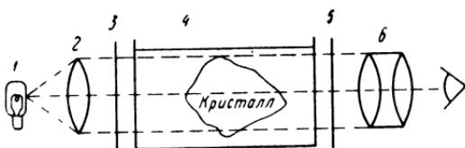
Рис. 1-6. Схема полярископа.
