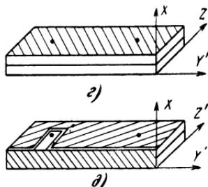
Рис. 3-15. Конфигурация электродов, наносимых на изгибные пьезоэлементы.
