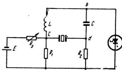
Рис. 4-17. Схема генератора на туннельном диоде с контуром полного волнового сопротивления.
