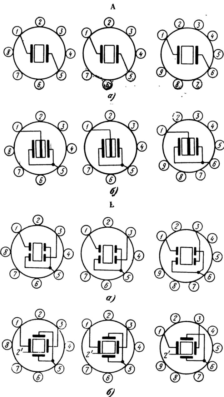
Рис. 3-6. Схемы цоколевки стеклянных вакуумных резонаторов,
