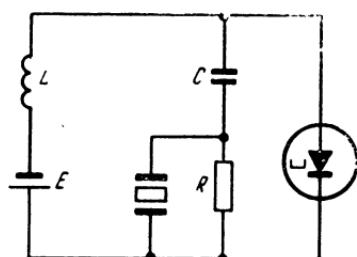
Рис. 4-19. Схема генератора на туннельном диоде с кварцевым резонатором в емкостной ветви контура.
