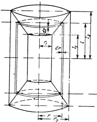
Рис. 4-25. Разрез термостата в направлении образующей цилиндра.
