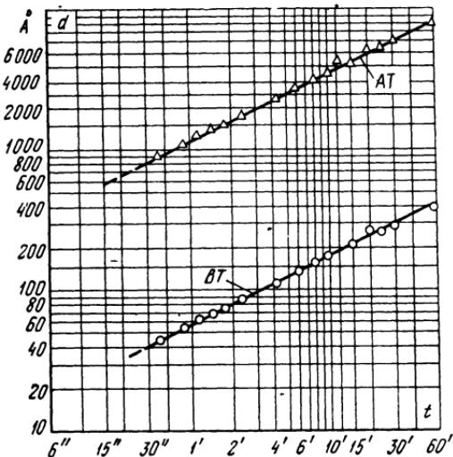
Рис. 2-14. Зависимость толщины травленого слоя, определяемой методом взвешивания, от времени травления (поверхность кварца  $BT$ -срезашлифована).
