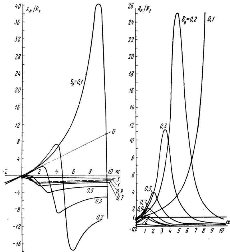
Рис. 4-12. Зависимость элементов последовательной схемы замещения кварцевого резонатора  $x_h/R_1=f(\alpha)$  и  $R_h/R_1=f(\alpha)$ .
