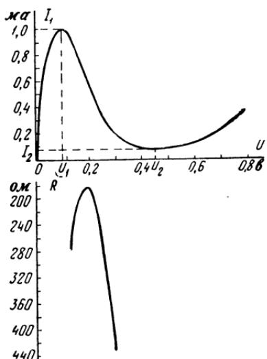
Рис. 4-16. Вольт-амперная характеристика туннельного диода и зависимость дифференциального отрицательного сопротивления  $R_0$  от напряжения на диоде.
