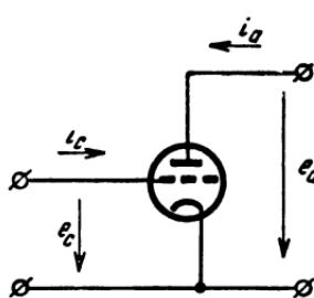
Рис. 4-15. Токи и напряжения в лампе.
