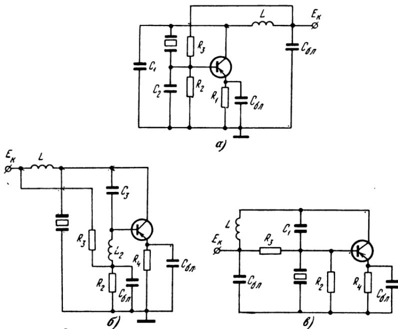
Рис. 4-4. Схемы генераторов «параллельного» резонанса.
