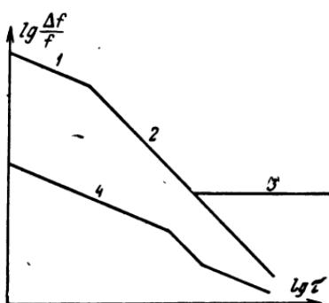
Рис. 4-3. Кратковременная стабильность кварцевых генераторов как функция периода выборки.
