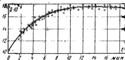
Рис. 2-19. Зависимость добротности от длительности травления кварца.
