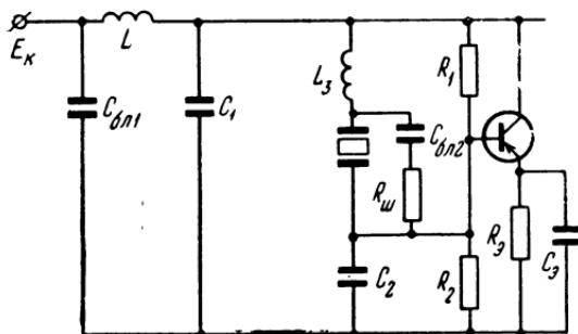
Рис. 4-23. Схема генератора с кварцевым резонатором в контуре.
