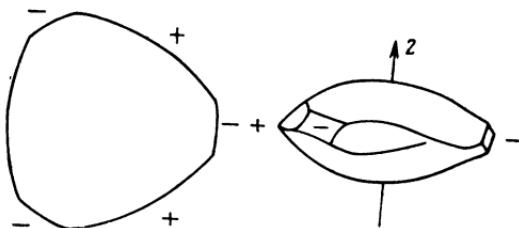
Рис. 1-8. Шар, изготовленный из правого кристалла кварца, после травления плавиковой кислотой в течение месяца.
