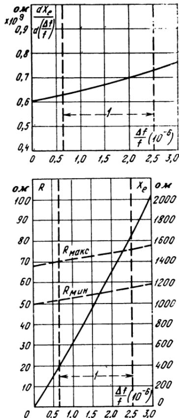
Рис. 4-2. Зависимость реактивного и активного сопротивления кварцевого резонатора от относительного изменения частоты.
