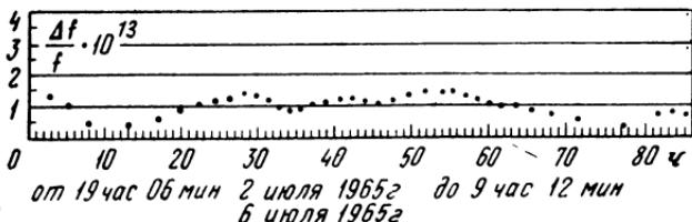
Рис. 5-6. Результаты измерений разностной частоты двух квантовых водородных генераторов. Данные получены методом наблюдений за низкочастотными биениями двух генераторов.
