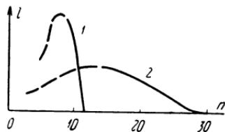
Рис. 2-2. Нормальное (1) и недостаточное (2) распределение глубоких трещин, оставшихся после полирования.
