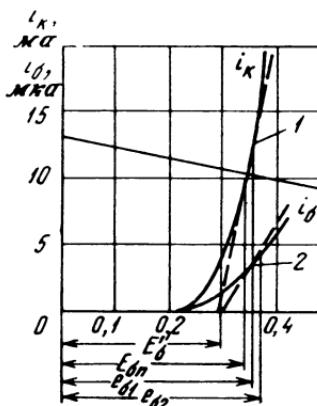
Рис. 4-20. Экспериментальные (пунктирные линии) характеристики транзистора (значения токов увеличены в 10 раз)
