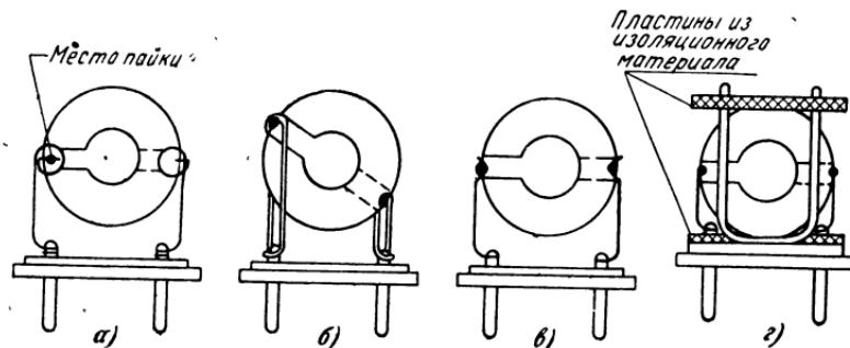
Рис. 3-4. Типы конструкций кварцодержателей высокочастотных герметизированных резонаторов.
