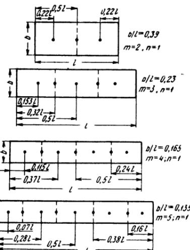
Рис. 3-18. Расположение узловых точек у пьезоэлементов *DT*-среза при различных модах колебаний.
