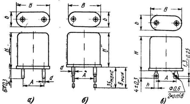
Рис. 3-3. Внешний вид резонаторов видов М1 и Б1 (а), М2 и Б2 (б), М3 и Б3 (в). (Размеры указаны в табл. 3-1).
