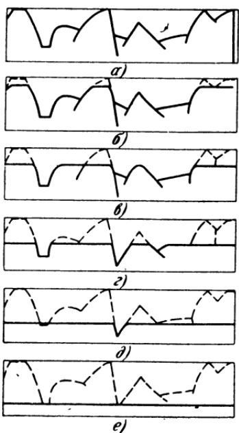
Рис. 2-1. Схема полирования по Брюхе и Поппа.
