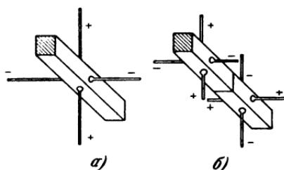
Рис. 3-16. Конструкция кварцевого вибратора при крутильных колебаниях на основной частоте (а) и на второй гармонике (б).
