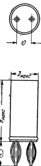
Рис. 3-1. Внешний вид и габариты резонатора в пластмассовом корпусе.
