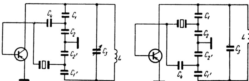
Рис. 4-8. Варианты схем квадровых генераторов с нейтрализацией статической емкости.
