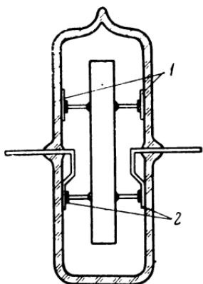
Рис. 3-10. Конструкция двухполюсного бескаркасного резонатора, пьезоэлемент которого монтируется на четырех проволочных отводах.
