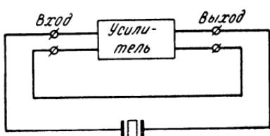
Рис. 4-6. Обобщенная эквивалентная схема генераторов последовательного резонанса.
