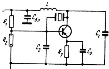
Рис. 4-22. Схема генератора с кварцевым резонатором между коллектором и базой.
