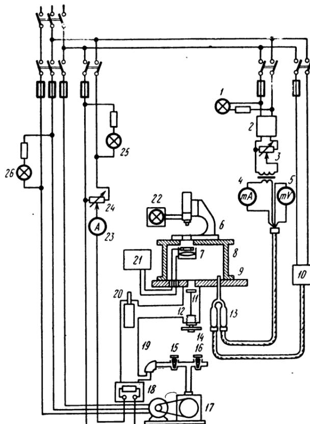
Рис. 2-23. Схема высоковакуумной установки.
