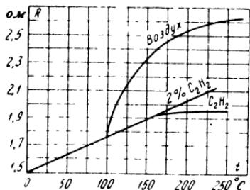
Рис. 2-22. Зависимость сопротивления пленок серебра от температуры и среды.
