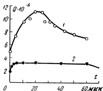
Рис. 2-15. Зависимость добротности кварца от продолжительности его травления.
