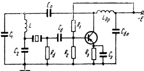
Рис. 4-24. Схема генератора с кварцевым резонатором в цепи обратной связи.
