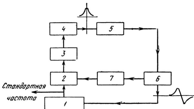
Рис. 5-3. Блок-схема генератора, стабилизированного атомным резонатором.
