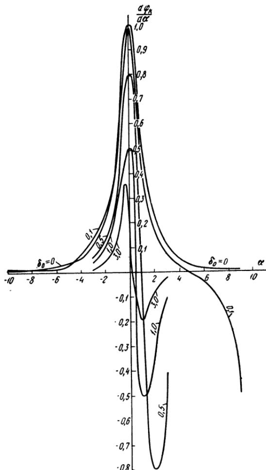
Рис. 4-13. Зависимость крутизны фазовой характеристики резонатора от обобщенной расстройки  $d\varphi_k/d\alpha = f(\alpha)$ .
