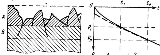
Рис. 2-3. Схема распределения поверхностного и приповерхностного слоев при полировании.
