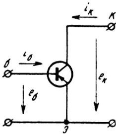
Рис. 4-14. Токи и напряжения в транзисторе.
