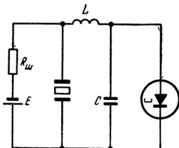
Рис. 4-18. Схема генератора на туннельном диоде с кварцевым резонатором в индуктивной ветви контура.
