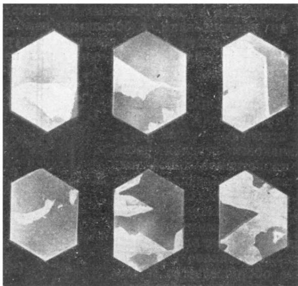
Рис. 1-15. Образцы дофинейских двойников, обнаруживаемых путем травления на плоскости базиса.
