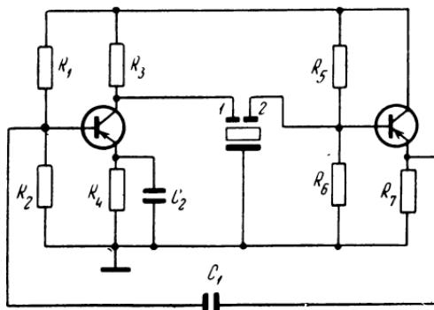
Рис. 4-9. Схема генератора Кэди для возбуждения трехполюсных кварцевых резонаторов.
