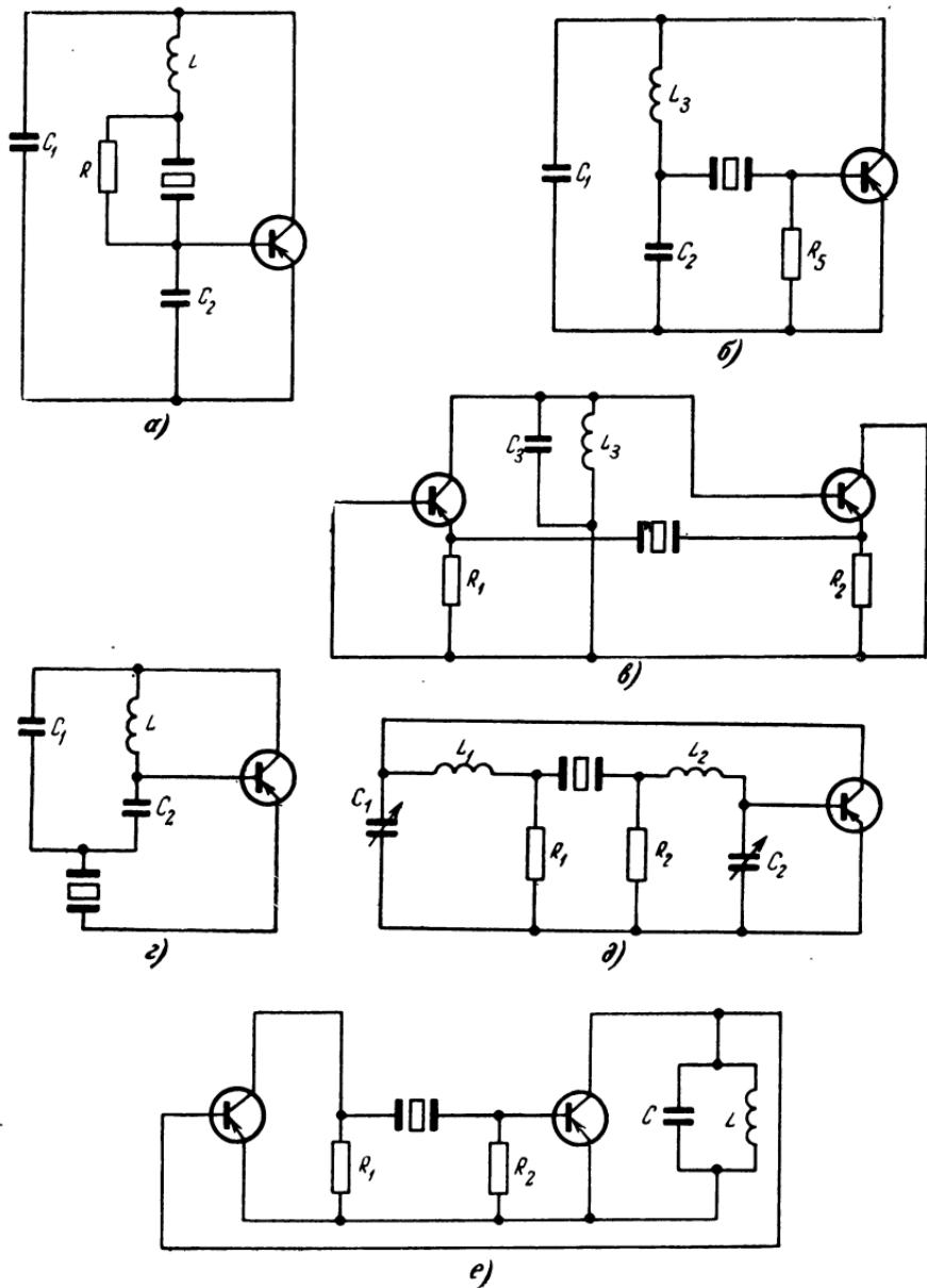
Рис. 4-7. Схемы генераторов последовательного резонанса.
