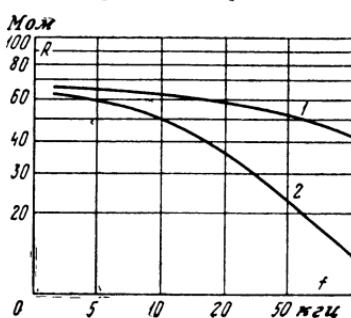
Рис. 2-21. Зависимость сопротивления золотой пленки от частоты.
