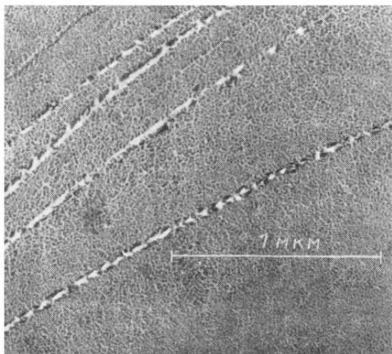
Рис. 2-4. Электронно-микроскопический снимок поверхности кварца с «бороздами».
