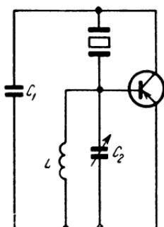
Рис. 4-5. Эквивалентная схема емкостной трехточки для возбуждения кварцевых резонаторов на гармониках.
