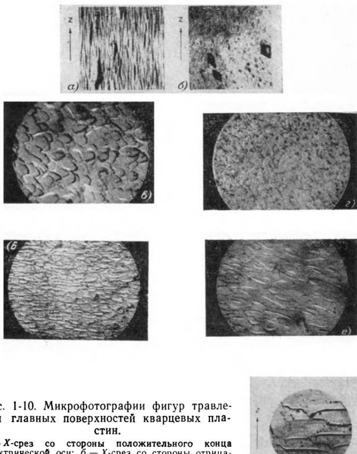
Рис. 1-10. Микрофотографии фигур травления главных поверхностей кварцевых пластин.
