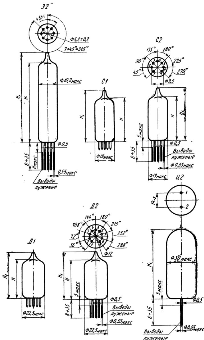
Рис. 3-5. Габаритные и присоединительные размеры стеклянных вакуумных резонаторов по ГОСТ 11599-67.
