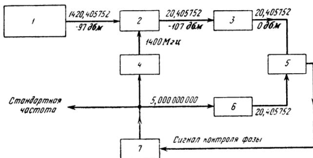
Рис. 5-4. Блок-схема стандарта частоты на основе квантового водородного генератора.
