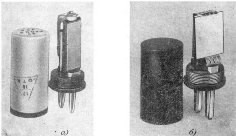
Рис. 3-2. Внутреннее устройство высокочастотных кварцевых резонаторов в пластмассовом корпусе.
