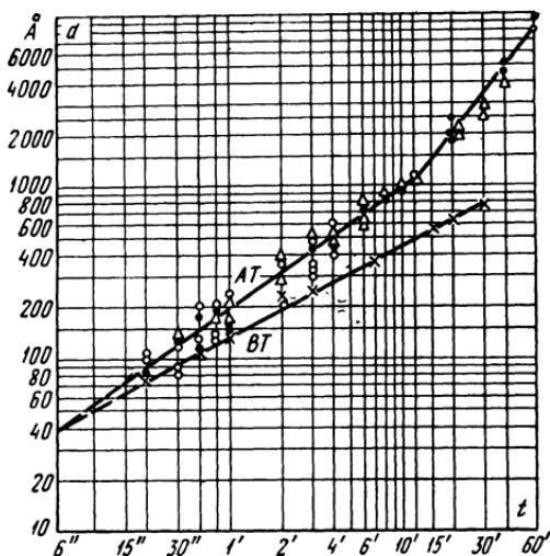
Рис. 2-13. Зависимость толщины травленого слоя, определяемой интерференционным методом, от времени травления (поверхность кварца AT- и BT-среза полирована).
