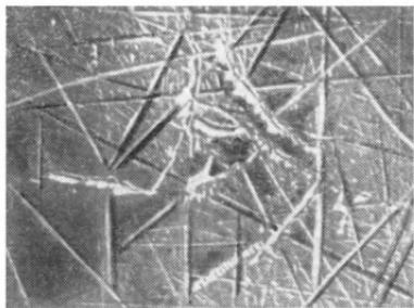
Рис. 2-11. Полированная и проправленная в плавиковой кислоте поверхность стекла.
