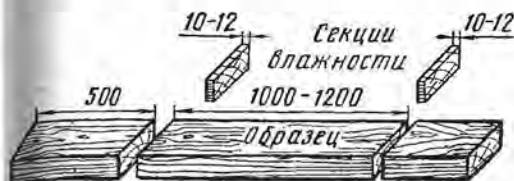
Рис. 79. Схема выпиливания контрольных образцов и секций для определения их начальной влажности
