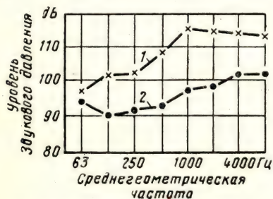
Рис. 46. Кривые, характеризующие эффективность применения звукопоглощающих матов:
