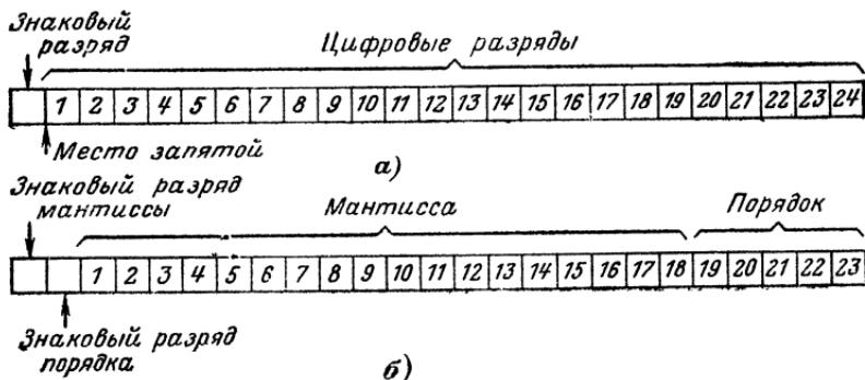
Рис. 9-15. Разрядная сетка ЭВМ.
