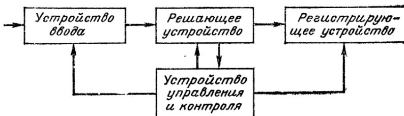
Рис. 9-4. Обобщенная схема АВМ:
