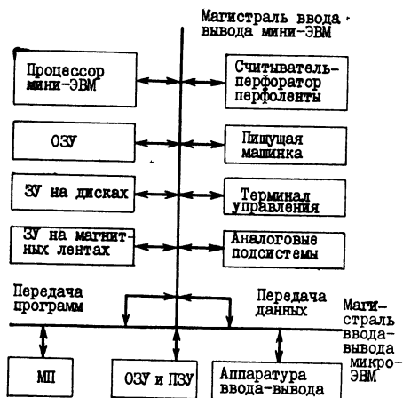
Рис. 8-6. Система микро- и мини-ЭВМ для проектирования программного обеспечения микро-ЭВМ.
