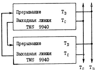
Рис. 5-4. Схема обмена данными двух микро-ЭВМ TMS 9940 в многопроцессорной системе по каналам T_C и T_D .
