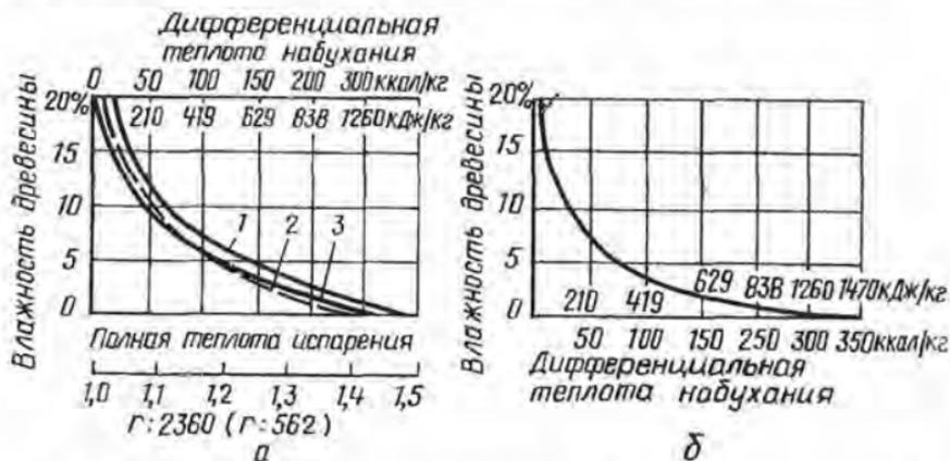
Рис. 27. Дифференциальная теплота сорбции влаги древесиной:
