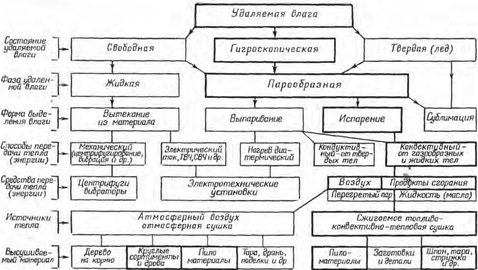
Рис. 2. Структурная схема различных методов и процессов обезвоживания древесины
