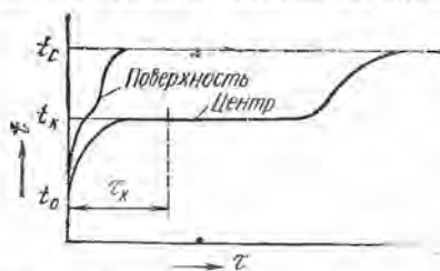
Рис. 77. Кривые изменения температуры древесины во времени при жидкостной сушке
