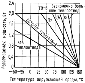
Максимальная усредненная рассеиваемая мощность (LM109H).
