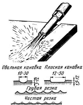
Рис. 68. Поверхностная кислородная резка и формы выплавляемых канавок
