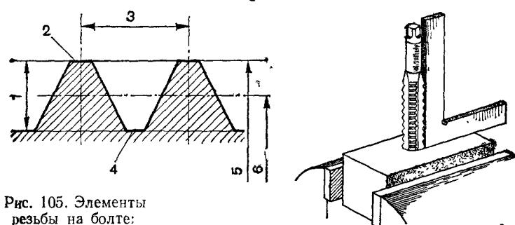
Рис. 105. Элементы резьбы на болте:
