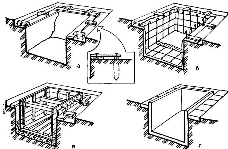
Рис. 193. Этапы бетонирования прямоугольного купального бассейна.
