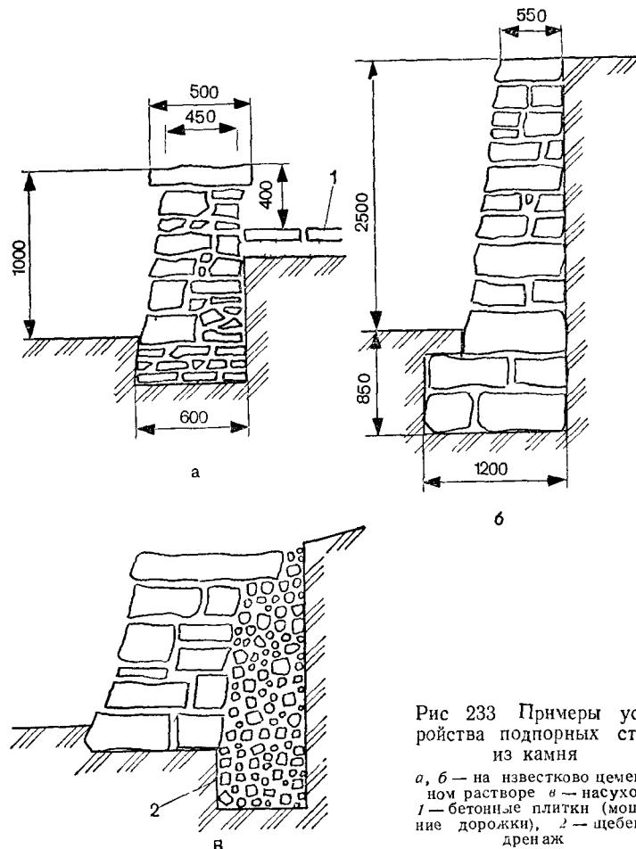
Рис. 233 Примеры устройства подпорных стен из камня
