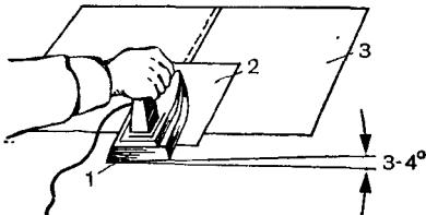
Рис. 117. Сваривание поливиниловой пленки при помощи электрического утюга:
