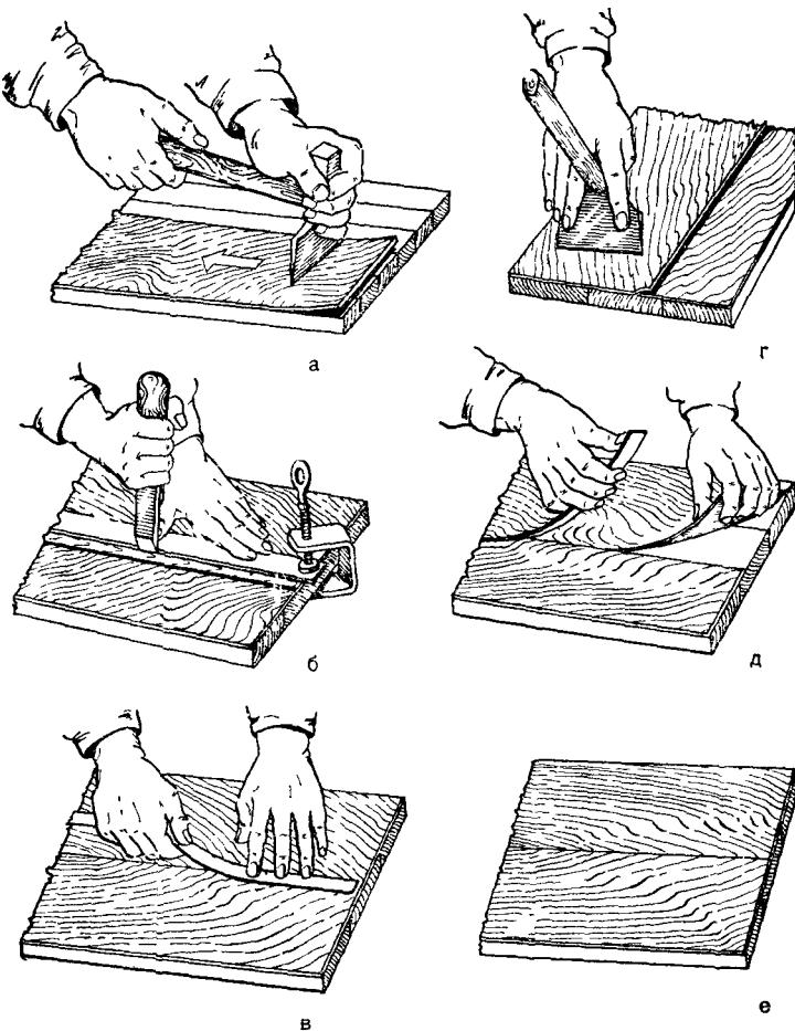
Рис. 78. Фанерование впритирку отдельными листами шпона:
