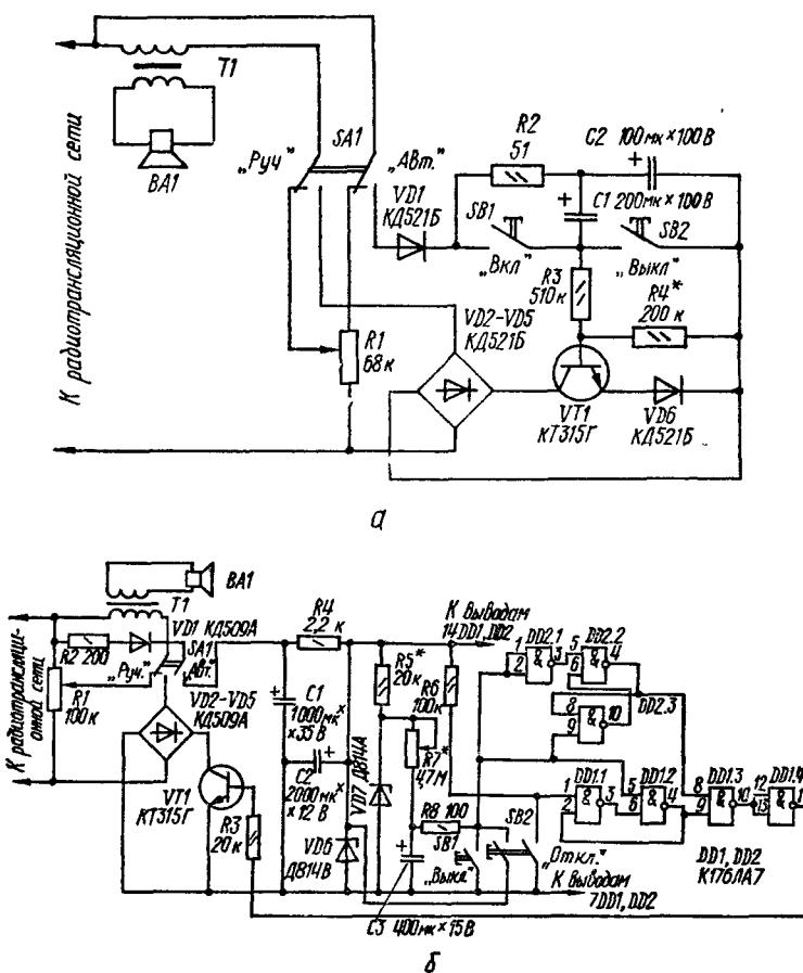
Рис. 262. Принципиальная электрическая схема устройства управления громкоговорителем:
