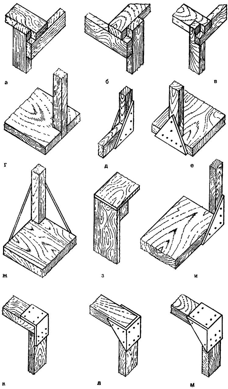
Рис. 70. Соединения деревянных элементов: а — м — на гвоздях.
