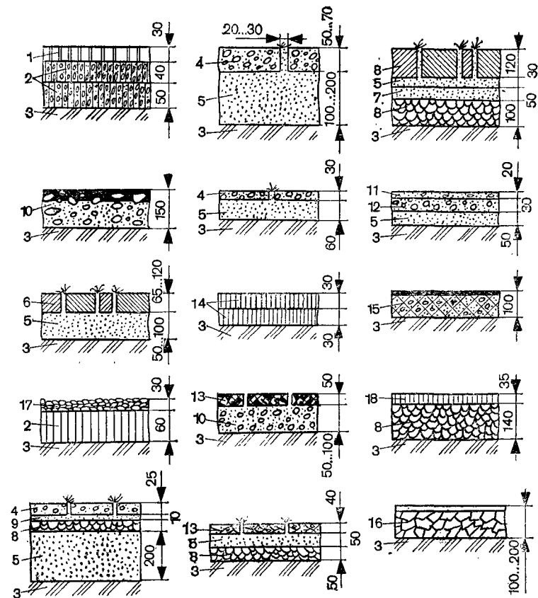
Рис. 225. Конструкция некоторых покрытий дорожек и площадок:
