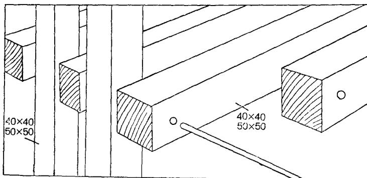
Рис. 142 Конструкция стеллажей
