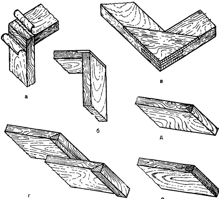
Рис. 73. Подготовка углов и торцов к фанерованию:
