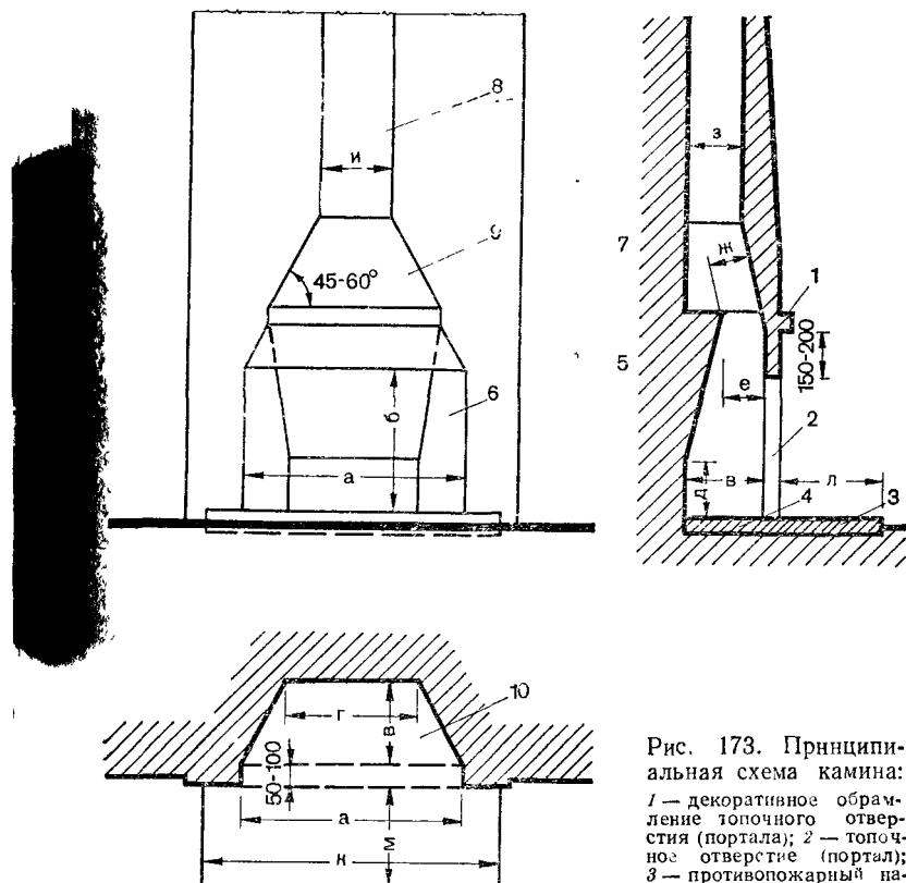
Рис. 173. Принципиальная схема камина:
