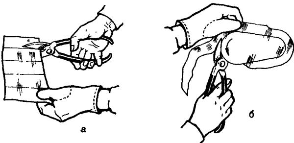
Рис. 97. Резка металла ножницами:
