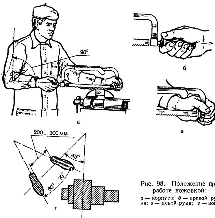
Рис. 98. Положение при работе ножовкой:
