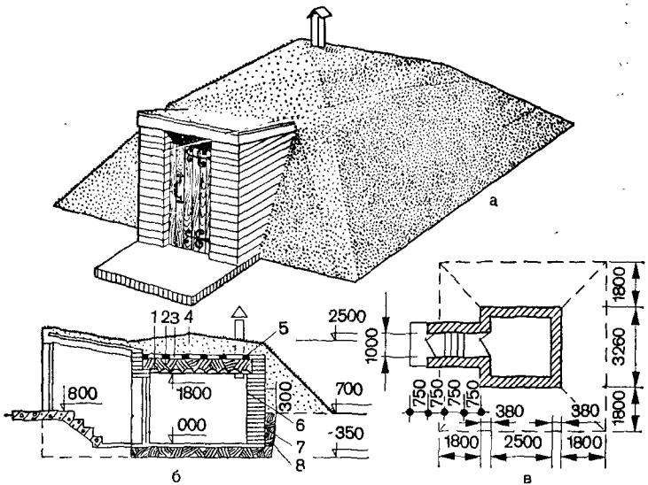
Рис. 217. Полуподземный погреб:
