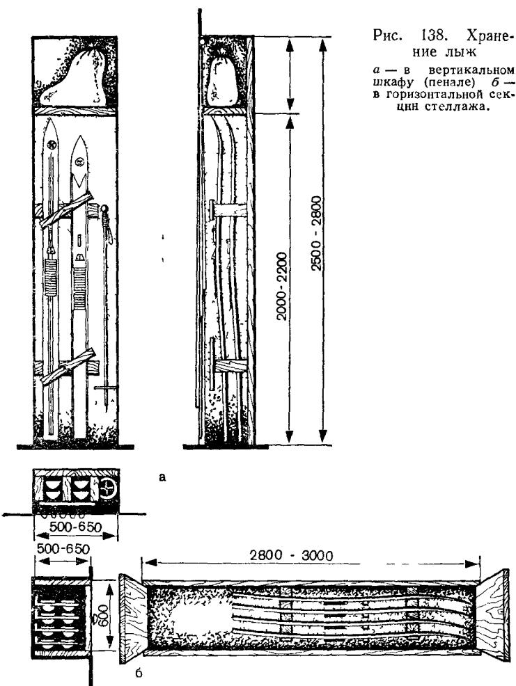
в котором разместятся две пары лыж с палками и лыжными ботинками (рис. 138, а). В шкафу перпендикулярно к его задней стенке вверху и внизу закрепляют отрезки рейки сечением 50 × 50 мм. К средней рейке на шурупе привинчивают вращающуюся планку, удерживающую лыжи в вертикальном положении. Повернув эту планку в вертикальное положение, можно вынуть лыжи из шкафа. Для подвески лыжных палок в шкафу следует предусмотреть крючок.
