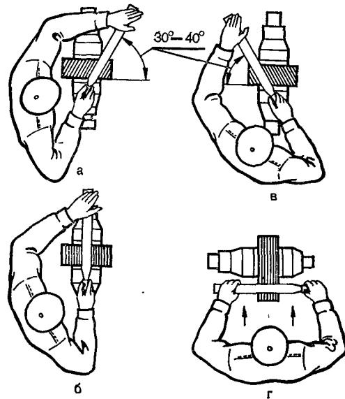
Рис. 101. Опиливание поверхности:
