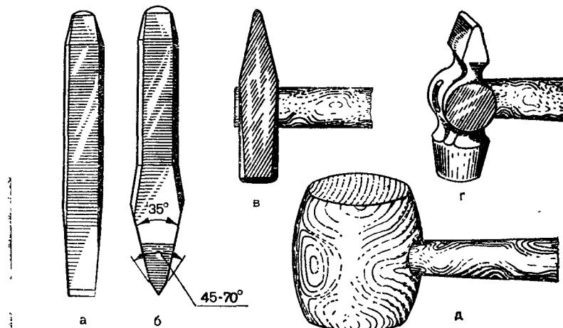
Рис. 24. Инструменты для рубки металла:
