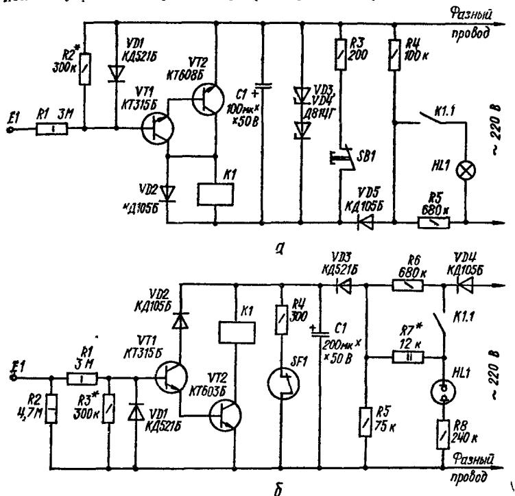
Рис. 249. Принципиальная электрическая схема сигнализатора ухода:
