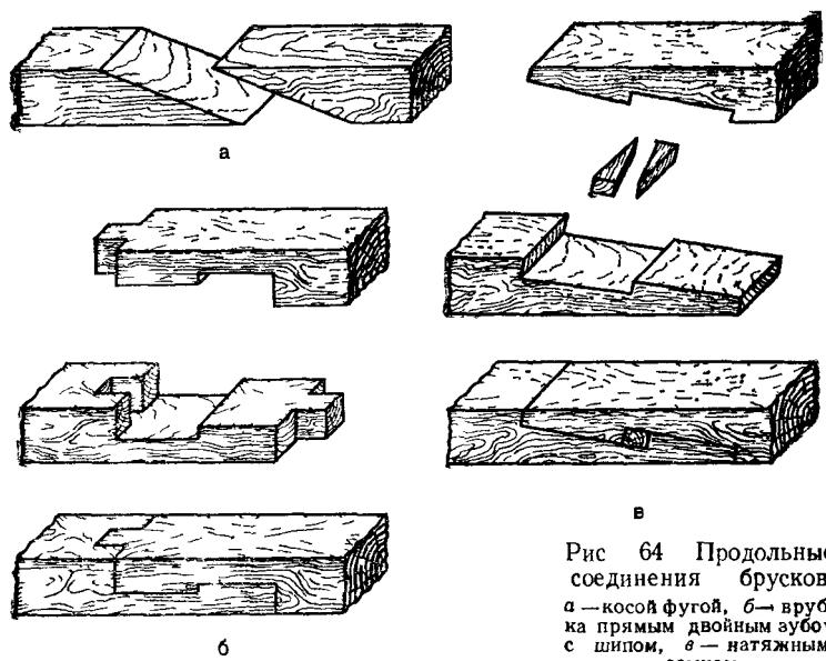
Рис 64 Продольные соединения брусков:
