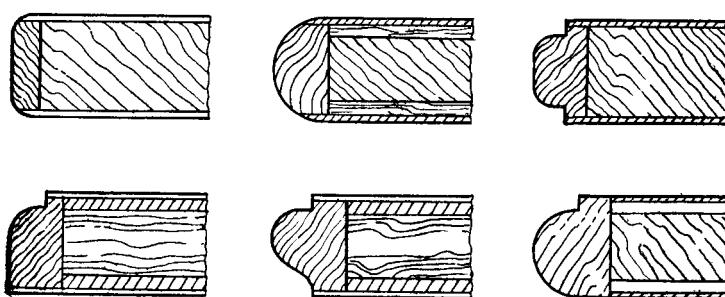
Рис. 82. Наклеивание брусков на кромки фанерованной детали
