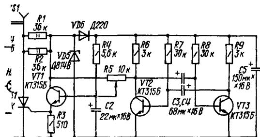
альная электрическая схема переключателя елочных световых импульсов.
