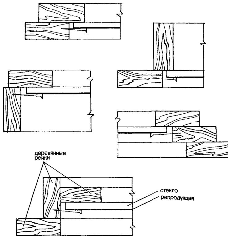
Рис. 158. Изготовление рамок из реек прямоугольного сечения.
