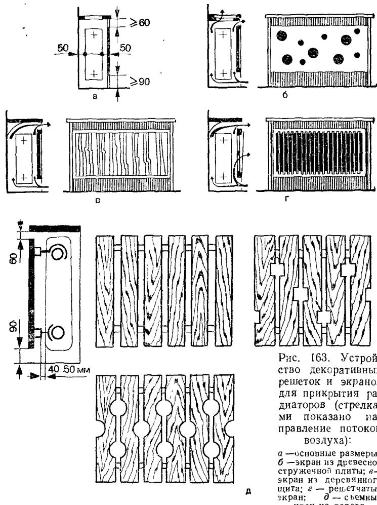
Рис. 163. Устройство декоративных решеток и экранов для прикрытия радиаторов (стрелками показано направление потоков воздуха):
