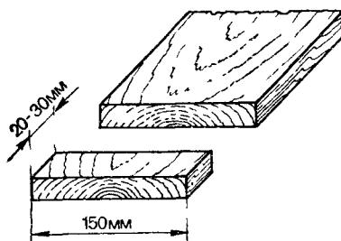
Рис. 49. Брускочек для определения влажности древесины.
