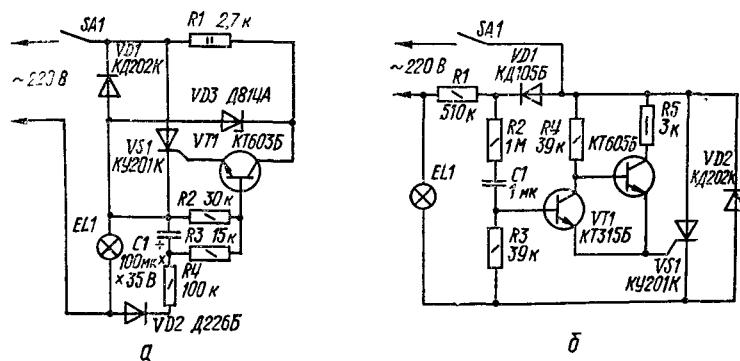
Рис. 250. Принципиальная электрическая схема устройства включения лампы накаливания:
