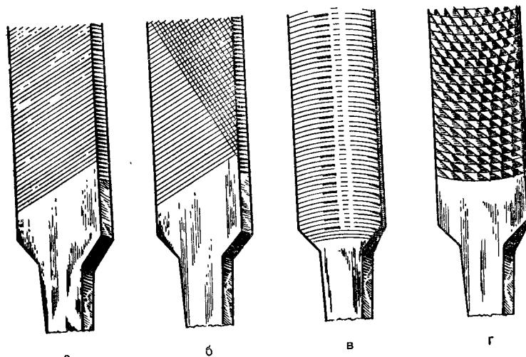
Рис. 27. Виды насечки напильников:
