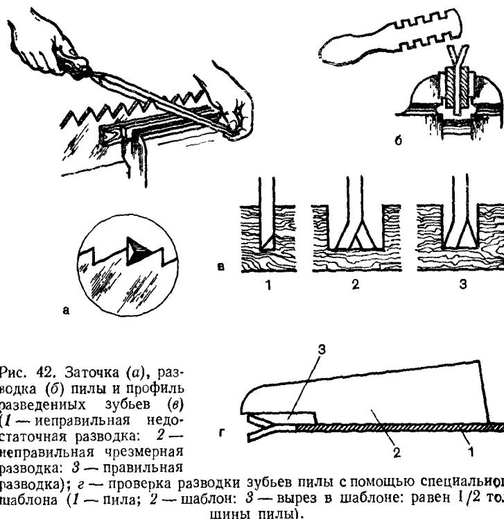
Рис. 42. Заточка (а), разводка (б) пилы и профиль разведенных зубьев (в) (1 — исправильная недостаточная разводка; 2 — неправильная чрезмерная разводка; 3 — правильная разводка); г — проверка разводки зубьев пилы с помощью специального шаблона (1 — пила; 2 — шаблон; 3 — вырез в шаблоне: равен  $1/2$  толщины пилы).
