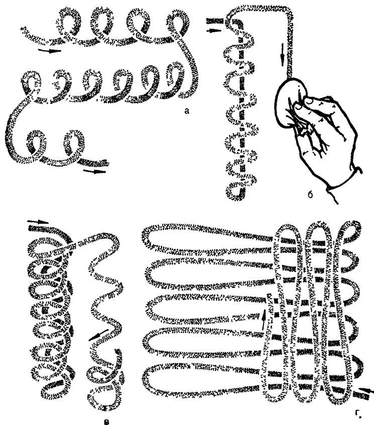
Рис. 85. Схема нанесения ласов при полировке:
