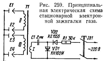
Рис. 259. Принципиальная электрическая схема стационарной электронной зажигалки газа.
