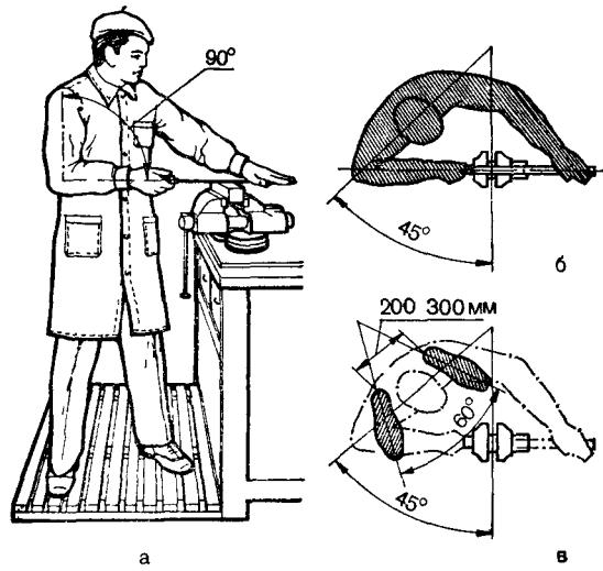
Рис. 100. Положение при опиливании:
