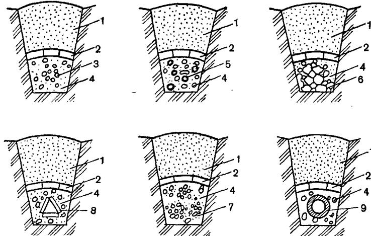
Рис. 219. Конструкция дрен из местных материалов:
