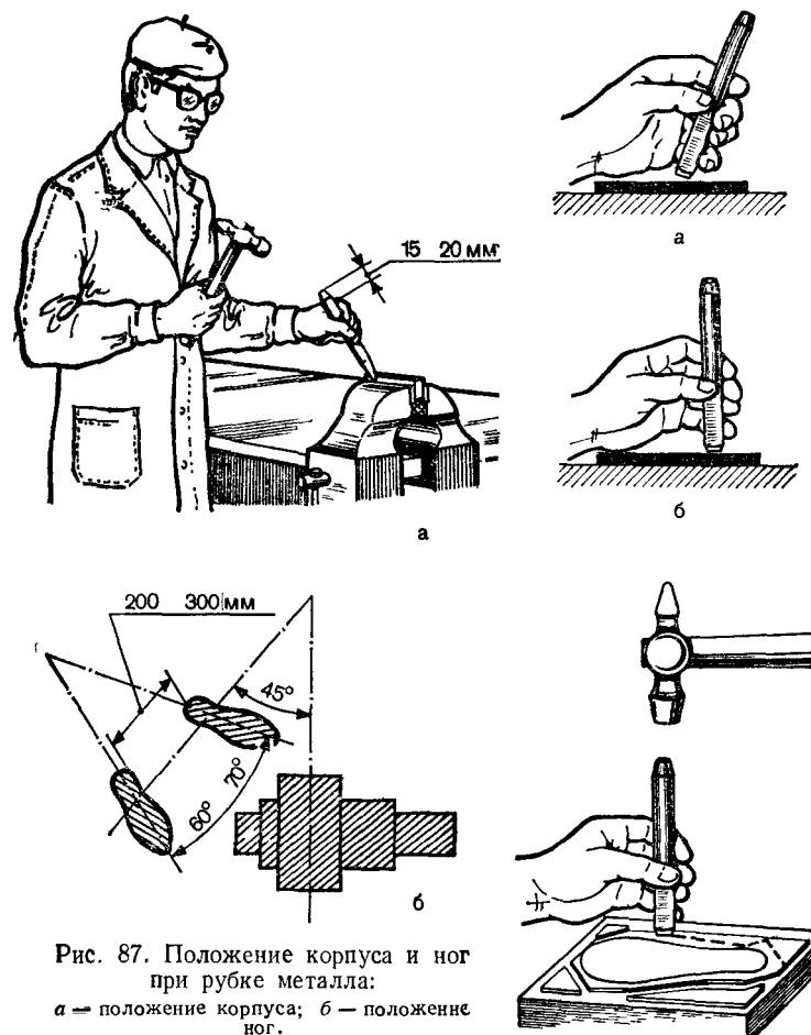
Рис. 87. Положение корпуса и ног при рубке металла:
