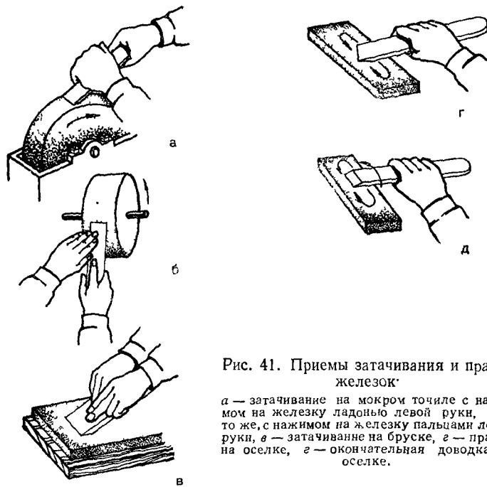
Рис. 41. Приемы затачивания и правки железок
