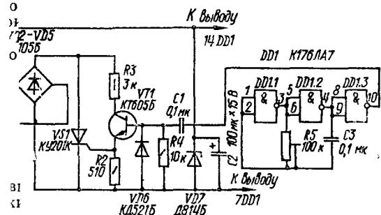
альная электрическая схема переключателя елочной гирлянды с плавным зажиганием.
