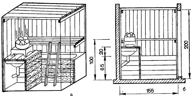
Рис. 180. Устройство сауны в ванной комнате:
