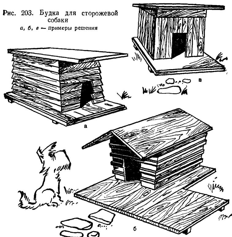
прибывают доски горизонтально с промежутками в 10—20 мм, промежутки перекрывают горизонтальными рейками, прибывают доски вертикально в два слоя, наружный слой перекрывает промежутки между досками первого слоя.
