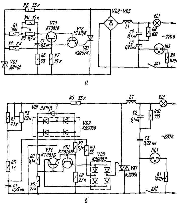
Рис. 245. Принципиальная электрическая схема триисторных регуляторов мощности:
