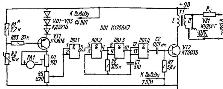
Рис. 261. Принципиальная электрическая схема терморегулятора.
