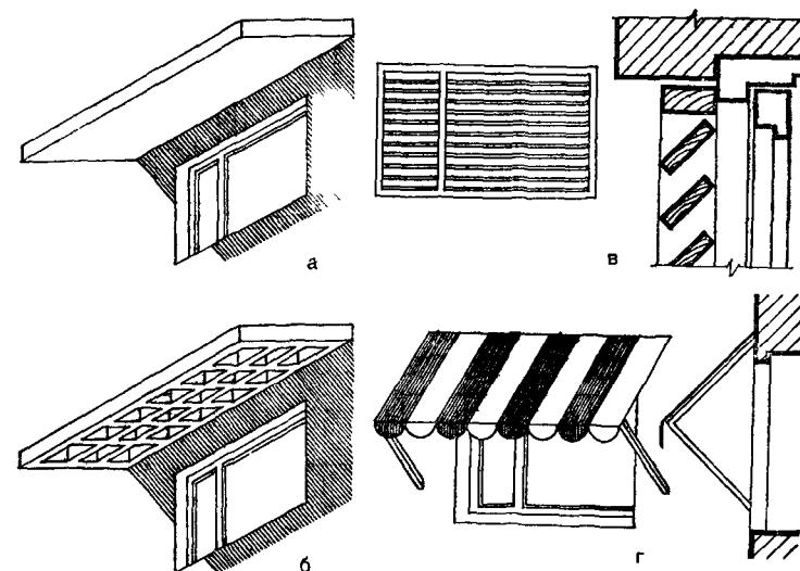
Рис. 169. Солнцезащитные устройства в усадебных жилых домах:
