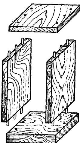
Рис. 71. Соединение стекок шкафчика на круглых
