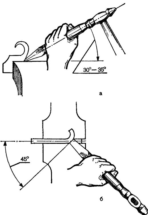
Рис. 89. Рубка листового металла в тисках:
