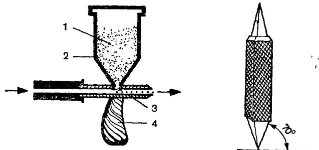
Рис. 37. Самодельный пескоструйный аппарат
