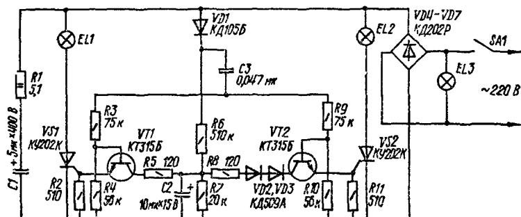
Рис. 251. Принципиальная электрическая схема устройства управления многоламповым светильником.
