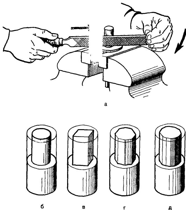
Рис. 102. Опиливание цилиндрического стержня до меньшего диаметра:
