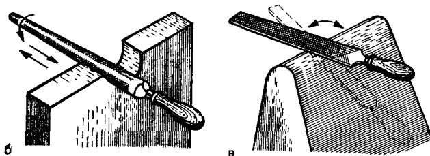
Такая система опиливания называется перекрестной. В результате ее применения получают ровную гладкую поверхность.
