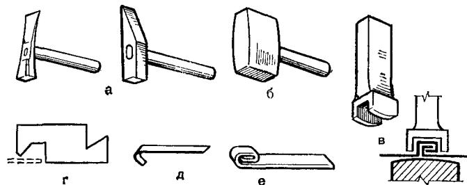
Рис. 36. Инструменты для устройства фальцевых соединений:
