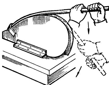
показано на рис. 96. Есть и другие способы гибки стальных труб в холодном состоянии, но они требуют специальных приспособлений.
