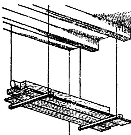
Рис. 48. Хранение брусьев и досок на перекладинах, подвешиваемых к балкам кровли.
