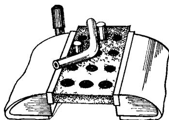
Рис. 96. Гибка трубы в холодном состоянии при помощи неподвижной оправки.
