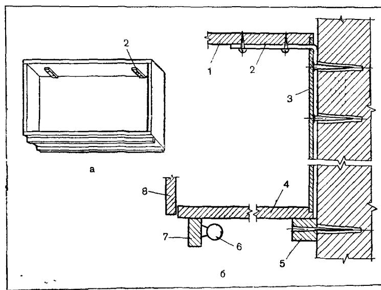
Навесной шкаф состоит из секций, количество которых определяют в зависимости от необходимости. Длину одной секции рекомендуется принимать 700—900 мм. Для изготовления секций необходим фанерованный щит толщиной 20—22 мм.
