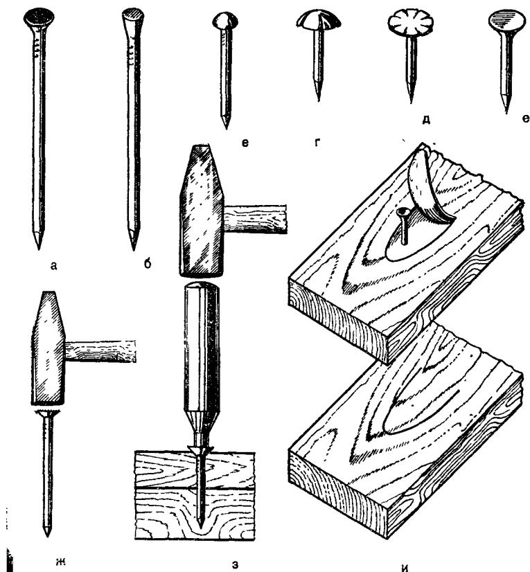
Рис. 68. Виды гвоздей и приемы соединения ими:
