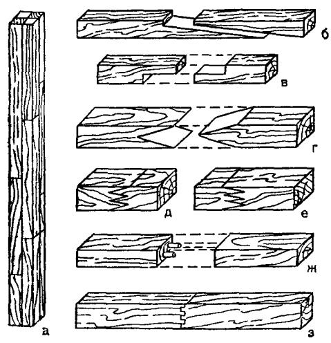
Рис 65 Сращивание деревянных элементов в мебельных работах при ремонте или замене отдельных частей изделий
