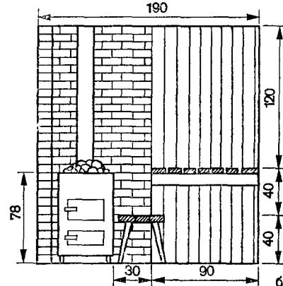
При обшивке внутренних поверхностей стен парилки доски располагают вертикально и соединяют в паз или в четверть. Под внутреннюю обшивку подкладывается пароизоляция из полиэтиленовой пленки. В верхней части внутренней обшивки полиэтиленовую пленку нужно выпустить над досками на 200 мм. Выступающая часть пленки подгибается и прижимается обшивкой потолка. Благодаря этому достигается необходимая хорошая пароизоляция стыка стен и потолка парилки.
