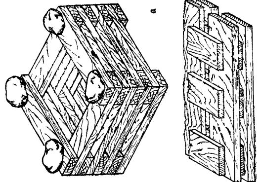
Рис. 47 Способы хранения брусьев
