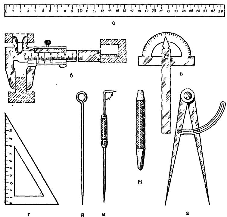
Рис. 23. Инструменты для измерений и разметки:
