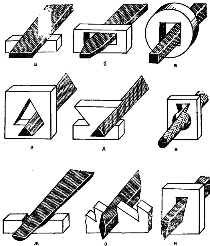
Рис. 28. Виды напильников по форме поперечного сечения:
