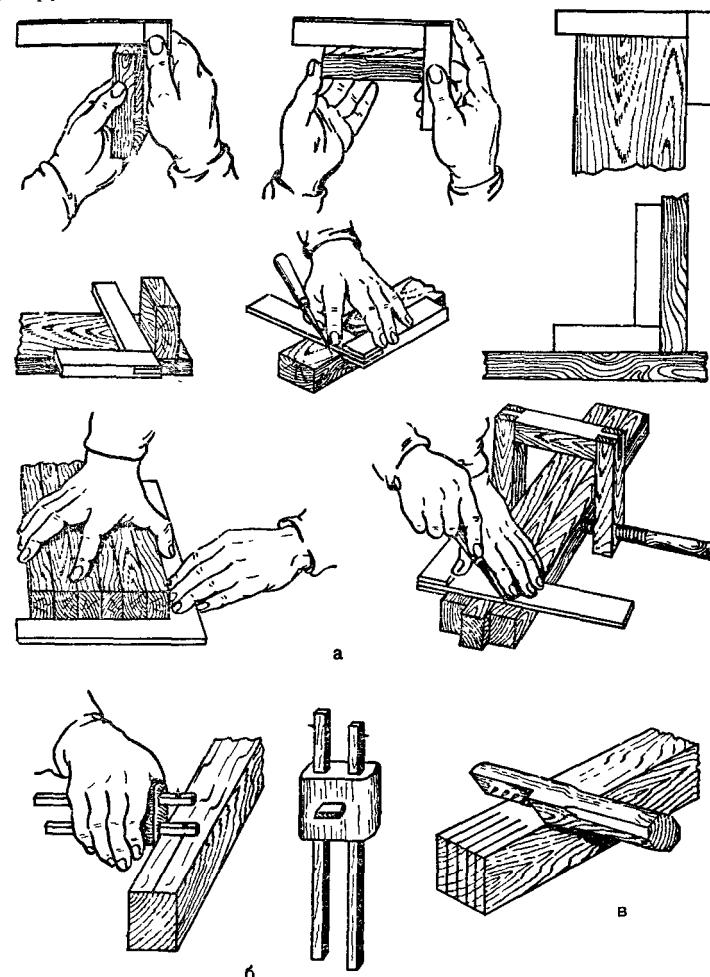
Рис. 15. Приемы работы разметочным инструментом:
