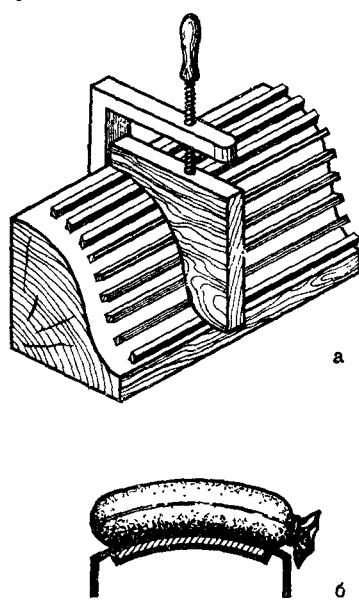
Рис. 83. Фанерование криволинейных поверхностей:
