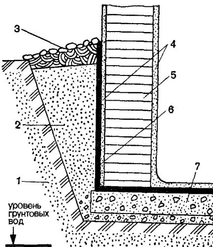
Безнапорная обмазочная гидроизоляция (рис. 220) устраивается для защиты погреба от поверхностных и фильтрационных вод в тех случаях, когда уровень грунтовых вод находится ниже основания погреба. Устройство гидроизоляции начинают с ошту-
