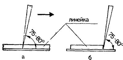
Рис. 86. Нанесение рисок чертилкой:
