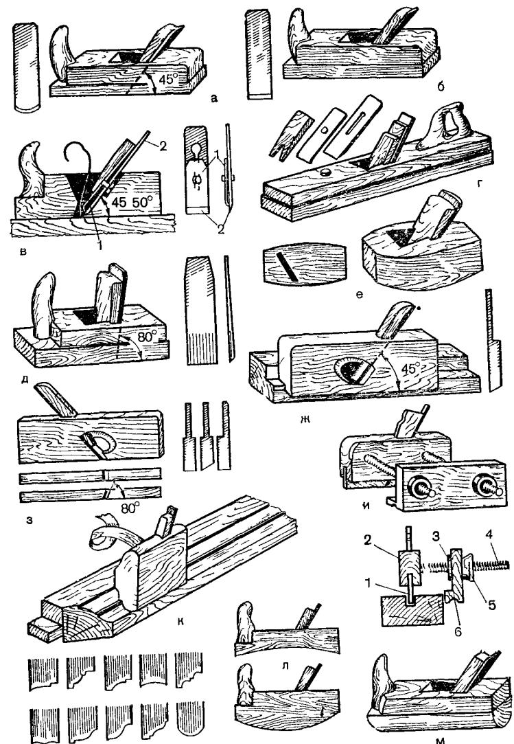
Рис 17 Инструменты для строгания
