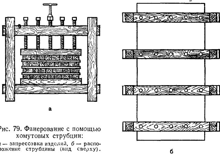
Рис. 79. Фанерование с помощью хомутовых струбцин:
