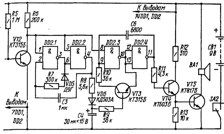
В случае обрыва линии связи закрывается транзистор *VT1*, что приводит к переключению элементов микросхемы *DD1* и срабатыванию сигнализатора.
