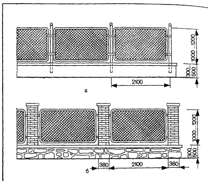
Рис. 235. Металлическая ограда из сетки, натянутой на рамы:
