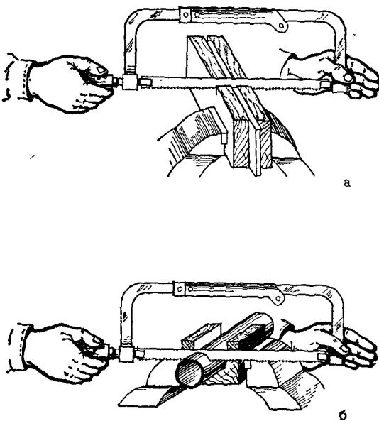
Рис. 99. Резка ножовкой:
