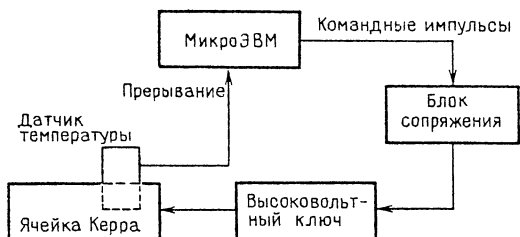
Р и с. 1.19. Состав аппаратуры для формирования высоковольтных импульсов и контроля температуры
