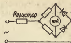
Рис. VI.8. Магнитоэлектрический прибор с выпрямителем
