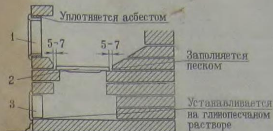
Рис. 9. Установка колосниковой решетки, топочной и поддувальной дверок
