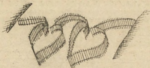
Рис. 16: Юнговый односторонний котцовый запор
