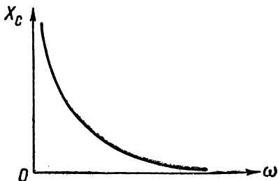
Рис. 216. Графики зависимости емкостного сопротивления конденсатора от угловой частоты
