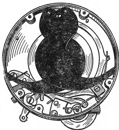
Рис. 25. Затвор ГОМЗ со снятой крышкой.
