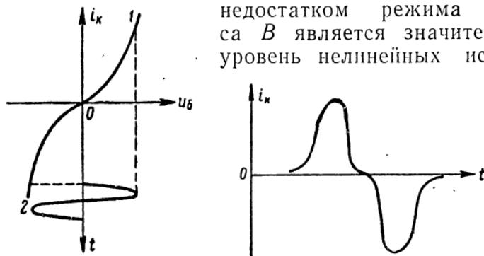
Рис. 3.8. Динамическая характеристика каскада, работающего в режиме класса  $B$ .
