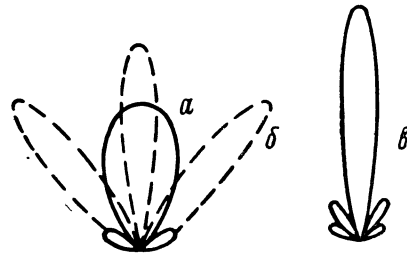
Рис. 9.7. Подавление вторичных главных лепестков в случае системы, состоящей из группы продольных излучателей: a — первичная диаграмма; б — групповая диаграмма; в — результирующая диаграмма.
