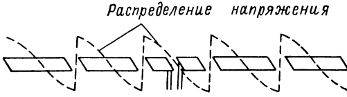
Рис. 8.43. Ряд коллинеарно расположенных диполей с емкостной связью.
